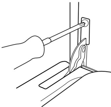
3. Fermer la porte du four à la position d'arrêt (ouvrir d'environ 4 po [10 cm]).
