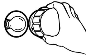
3. Dévisser l'ampoule dans le sens antihoraire pour la sortir de sa douille.
