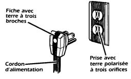
Le presse-ordures est conçu pour fonctionner avec une alimentation de 120 volts, 60 hz, c.a. seulement, sur un circuit avec fusibles de 15 ampères, mis à la terre comme il se doit et muni d'une prise avec terre comme le montre l'illustration cidessus. Pour votre sécurité personnelle, le presse-ordures doit être mis à la terre. Dans le cas d'un court-circuit électrique, la mise à la terre réduit les risques de choc électrique en fournissant un fil de
