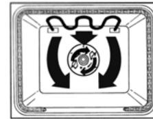
Durant la cuisson au gril par convection, les éléments de cuisson au gril s'allument et s'éteignent par intermittence pour maintenir la température du four et le ventilateur fait circuler constamment l'air chaud.
