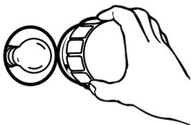
3. Dévisser l'ampoule dans le sens antihoraire pour la sortir de sa douille.
