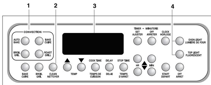
1. Commandes de convection (sur les modèles à convection seulement)
