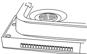
L'évent se ferme durant le programme pour assourdir le bruit dans le lave-vaisselle. À la fin du programme, l'évent demeure fermé jusqu'à ce que la vaisselle ait refroidi. Entre les programmes, il demeure ouvert pour une circulation de l'air et la réduction d'une accumulation d'odeurs.
