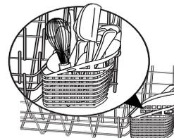
Le panier à ustensiles se suspend sur le panier inférieur dans le **coin droit**. Charger le panier à ustensiles pendant qu'il est sur le panier inférieur ou enlever le panier pour le charger sur un comptoir ou une table.
