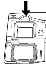
2. Verser le détergent dans la section pour le lavage principal. Voir "Quantité de détergent à utiliser."
