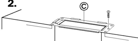
Quite el tornillo que fija la placa de la compuerta **C** a la parte superior del gabinete de la campana del horno. Deslice la compuerta lejos de las lengüetas de retención y quite la placa de la compuerta.
