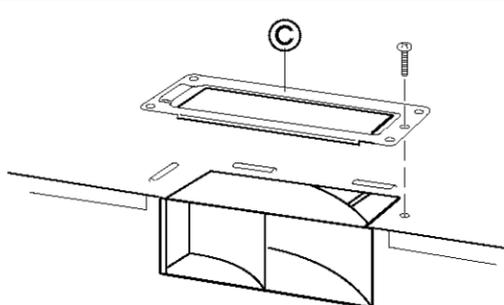
Deslice la placa de la compuerta **C** debajo de las lengüetas de retención. Vuelva a fijar la placa de la compuerta con el tornillo.
