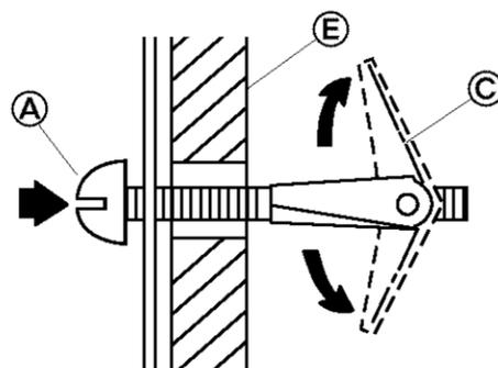
Apriete con los dedos los pernos acodillados (A) para asegurarse de que las tuercas acodilladas de resorte (C) se hayan abierto contra el muro interior sin mortero (E).
