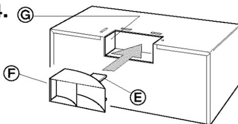
Gire el deflector de aire de manera que las aletas del deflector **E** queden orientadas hacia la parte delantera del horno de microondas y la lumbrera de escape pequeña **F** del deflector de aire quede orientada hacia la lumbrera de escape **G** de la campana del horno.
