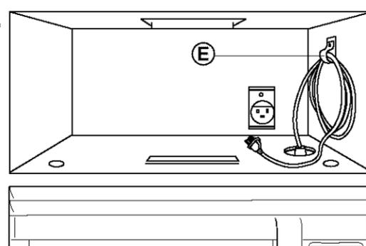
Enrolle el cable de alimentación en la abrazadera (E). Fije la abrazadera a la pared lateral del gabinete con el tornillo oscuro.
