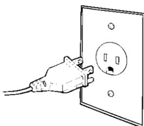
Enchufe el cable de alimentación en el tomacorriente puesto a tierra. Vuelva a conectar el suministro de energía.
