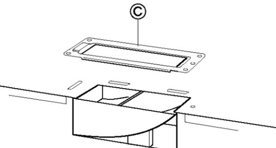
Deslice la placa de la compuerta **C** debajo de las lengüetas de retención. Guarde el tornillo para usarlo posteriormente.
