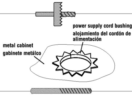
Use a broca de barrena o una sierra de calar para hacer un orificio de 2" de diámetro en el área sombreada marcada "M" en la plantilla del gabinete superior.
