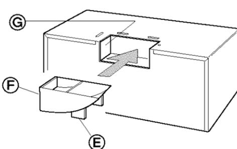
Gire el deflector de aire de manera que las aletas del deflector **E** queden orientadas hacia la parte inferior de la campana del horno de microondas y la lumbrera de escape pequeña **F** del deflector de aire quede orientada hacia la lumbrera de escape de la campana del horno **G**.
