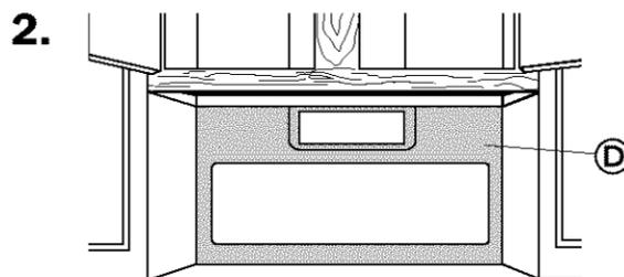
Coloque la placa de montaje (D) en la pared. Empuje los pernos acodillados (A) y las tuercas (C) a través del muro interior sin mortero (E).
