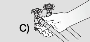
RACCORDER LE TUYAU D'EAU CHAUE À
