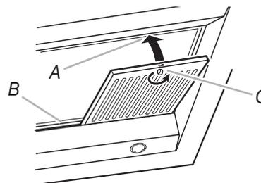
A. Logement d'insertion de la manette de verrouillage
