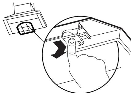
2. Installer les filtres à graisse - utiliser les deux mains; tirer d'abord et faire tourner le bouton vers la gauche pour que la tige de verrouillage ne dépasse pas du filtre.
