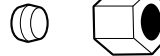
Tuerca de compresión de 1/4" y férula (manga) (modelos con máquina de hielos solamente)
