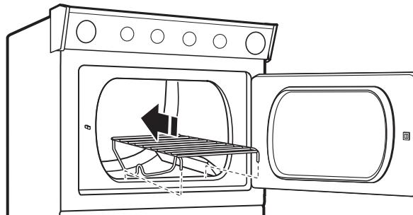
2. Alinee los dos ganchos que están en la parte frontal del estante de secado con los orificios que están en la abertura de la puerta de la secadora y presiónelos hacia abajo por completo dentro de los orificios. Coloque el soporte posterior sobre el borde posterior de la secadora.
