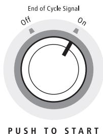
Su secadora puede tener la opción de End of Cycle Signal (Señal de fin de ciclo). La señal es útil cuando se secan prendas que se deben quitar de la secadora en cuanto se detiene. La Señal de fin de ciclo es parte del botón de PUSH TO START (Empuje para poner en marcha) y puede ser seleccionada. Gire el botón de PUSH TO START (Empuje para poner en marcha) a ON (Encendido) u OFF (Apagado). La señal sonará solamente si el selector está fijado en ON (Encendido).
