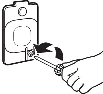
3. Gire el foco en sentido contrario a las manecillas del reloj. Reemplácelo únicamente con un foco para electrodomésticos de 10 vatios. Vuelva a colocar la cubierta en su lugar y asegúrela con el tornillo.
