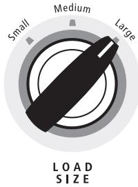
Seleccione el ajuste de LOAD SIZE (Talla de la carga) más adecuado para su carga. El ajuste de carga Small (Pequeña) agregará una pequeña cantidad de agua para las cargas pequeñas y el ajuste Large (Grande) agregará la mayor cantidad de agua para las cargas grandes o voluminosas. Los artículos deben moverse libremente.
