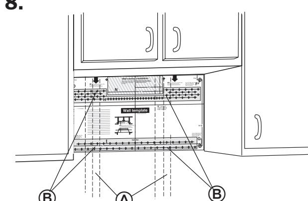
Verifique que los puntos "D" y "E", o "F" y "G" de la plantilla de pared estén sobre un montante de pared **A**: si los puntos están sobre un montante de pared, haga orificios de 3/16". Si los puntos están sobre un muro interior sin mortero, haga orificios de 3/4".
