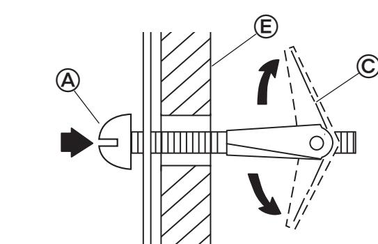
Apriete con los dedos los pernos acodilladas (A) para asegurarse de que las tuercas acodilladas de resorte (C) se hayan abierto contra el muro interior sin mortero (E).
