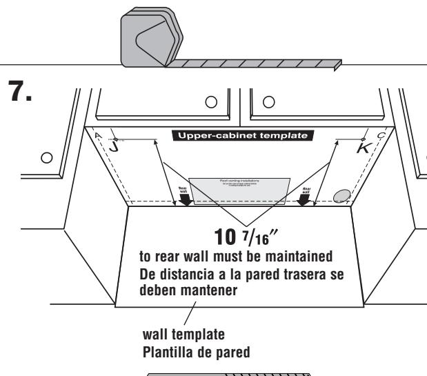
Coloque la plantilla de pared del gabinete superior contra la base del gabinete superior. Las flechas de la "Pared Trasera" deben estar contra la pared trasera de manera que los orificios hechos en la base del gabinete y los orificios en la parte superior del gabinete del horno microondas queden alineados.
