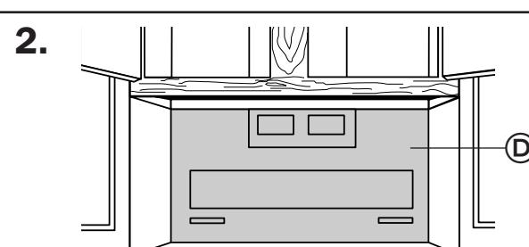
Coloque la placa de montaje (D) en la pared. Empuje los pernos acodillados (A) y las tuercas (C) a través del muro interior sin mortero (E).
