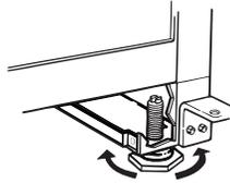
5. Pousser vers le haut sur la partie arrière de la machine à glaçons pour repérer les pieds de nivellement qui se trouvent sur le fond arrière de la machine à glaçons.
