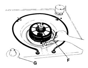
Le filtre à grosses mailles peut être enlevé au besoin. Pour enlever le filtre à grosses mailles, presser sa partie centrale (F), lever le filtre et le sortir du lave-vaisselle. Pour replacer le filtre, presser sa partie centrale afin que les agrafes s'emboîtent dans l'encoche carrée.
