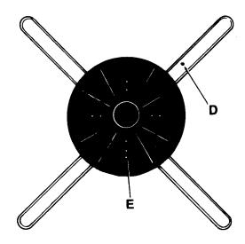
Le filtre amovible filtre continuellement l'eau de lavage et retient les particules d'aliments provenant de la vaisselle à l'extérieur du filtre. Ces particules d'aliments sont retirées du filtre par le jet d'eau provenant de l'unique bec gicleur (D) qui se trouve sous un bras du laveur. Le filtre ultra-fin est nettoyé par les neuf trous de giclement (E) situés au-dessous du laveur à 4 bras.
