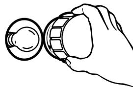
3. Tourner l'ampoule dans le sens inverse des aiguilles d'une montre et l'enlever de la douille.
