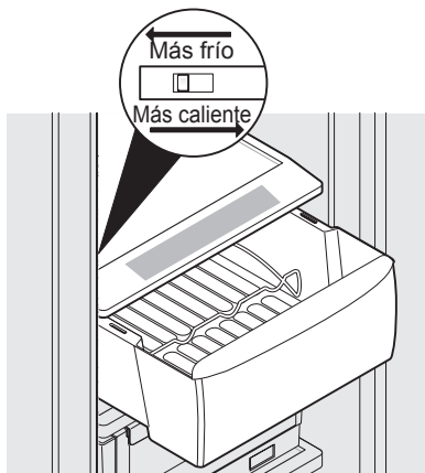
Cajón de enfriamiento con control de temperatura
