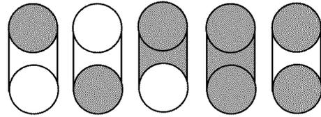
Utiliser la zone de pont afin d'obtenir le chauffage d'une zone de forme oblongue pour une cuisson au moyen d'un ustensile de cuisson de grande taille.
