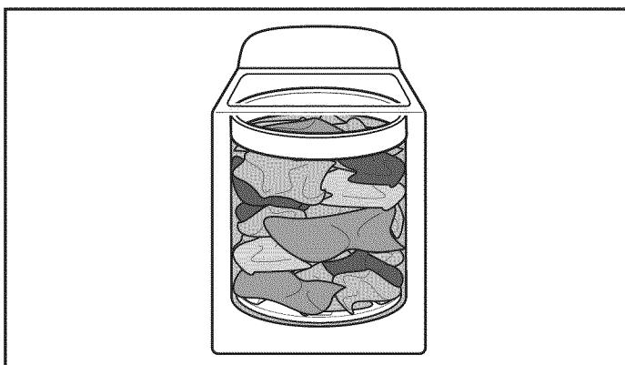
Lorsque l'on charge la laveuse de linge sale, celui-ci doit être réparti uniformément le long des parois du panier.
