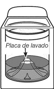
Lavadora con sistema de lavado de placa de lavado y bajo nivel de agua
