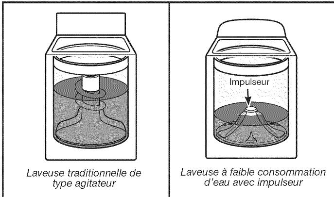
La nouveauté la plus flagrante de cette nouvelle laveuse est son système de lavage à faible consommation d'eau avec impulsor. La laveuse ajuste automatiquement le niveau d'eau en fonction de la taille de la charge - nul besoin de sélecteur de niveau d'eau.
