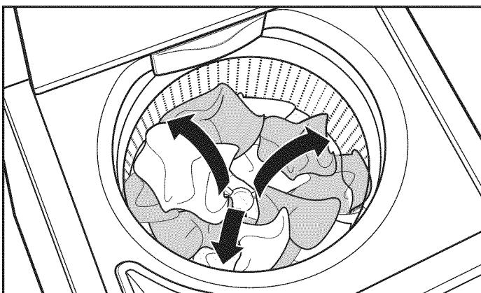
De faibles quantités d'eau sont ajoutées jusqu'à ce que la charge soit humide pendant que le panier continue de tourner lentement. Cette méthode de lavage avec faible consommation d'eau utilise moins d'eau et d'énergie qu'une laveuse traditionnelle de type agitateur.
