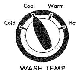
Una vez que haya seleccionado un ciclo, seleccione la temperatura de lavado deseada, girando la perilla de Temperatura de lavado (Wash Temp) hacia el ajuste deseado.
