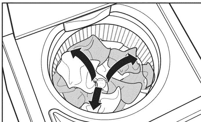
La placa de lavado mueve la carga mientras se agrega agua en cantidades pequeñas, hasta mojar la carga. Este método de lavado con bajo nivel de agua usa menos agua y energía, en comparación con el estilo tradicional de lavadora con agitador.
