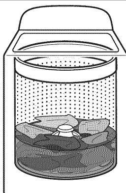
La mayor diferencia en su nueva lavadora es el sistema de lavado con placa de lavado y bajo nivel de agua. La lavadora regula automáticamente el nivel del agua de acuerdo al tamaño de la carga; no se necesita un selector de nivel de agua.
