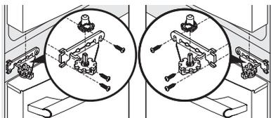
Cuando ambas puertas estén colocadas, verifique que estén alineadas entre sí y niveladas (consulte la sección de "Instalación" para más información) y vuelva a colocar la cubierta de la bisagra superior.
