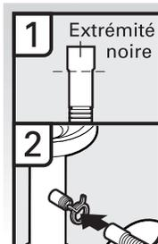
1. Raccorder l'extrémité noire du tuyau d'évacuation à la canalisation d'égout en T et couper si nécessaire. **REMARQUE :** Ne pas couper la section ondulée.
