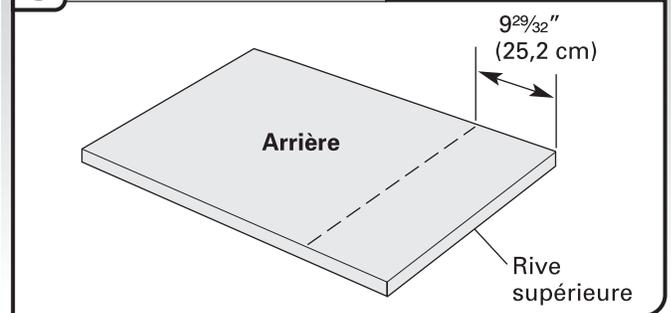
Mesurer  $9\frac{29}{32}$ " (25,2 cm) à partir de la rive supérieure. et tracer un axe à l'arrière du panneau personnalisé acheté par le client. Positionner le panneau externe à l'arrière du panneau personnalisé acheté par le client tel qu'illustré, de façon à ce que les trous supérieurs dans le panneau externe se trouvent sur l'axe et que les deux panneaux soient centrés côte à côte.
