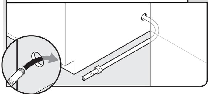
Acheminer lentement la canalisation d'alimentation en eau à travers le trou du placard. (On doit travailler prudemment si l'on utilise une canalisation de cuivre : celle-ci est malléable et se déforme ou s'écrase facilement.) La canalisation de cuivre doit s'avancer suffisamment loin dans l'ouverture d'encastrement du placard pour pouvoir être raccordée au point d'entrée du lave-vaisselle situé sur le côté avant gauche de celui-ci.
