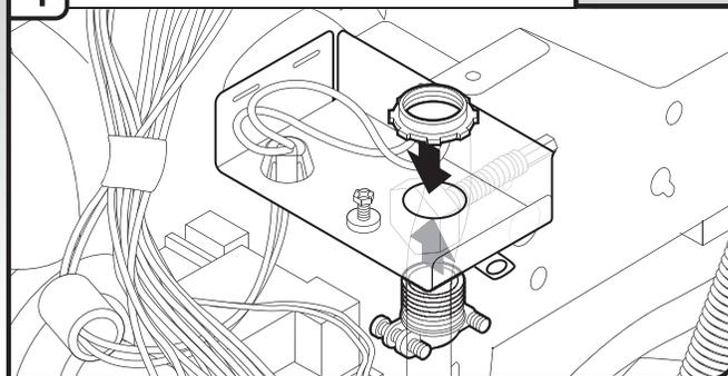
Installer un serre-câble (homologation UL ou CSA). S'assurer que les têtes de vis soient orientées vers la gauche lors du serrage de l'écrou à conduit. Le serre-câble est fourni avec le cordon d'alimentation.
