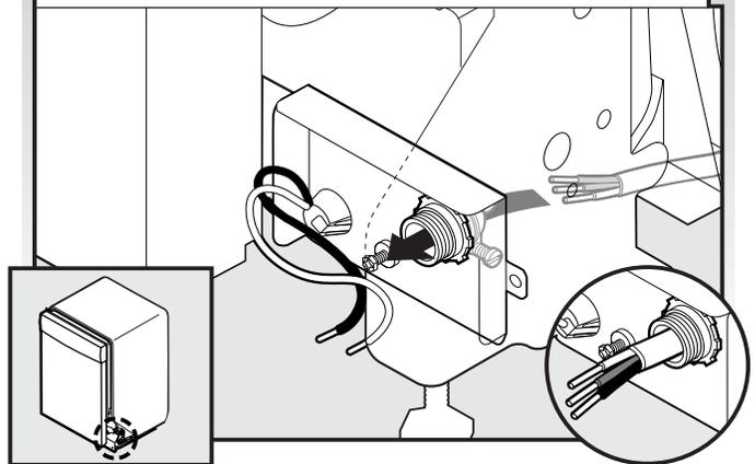
Acheminer le cordon d'alimentation de façon à ce qu'il ne touche ni le moteur du lave-vaisselle, ni la partie inférieure de la cuve du lave-vaisselle. Tirer le câble pour le faire passer à travers le serre-câble (homologation UL/CSA) dans le boîtier de connexion. Le serre-câble n'est pas fourni avec le lave-vaisselle. Le propriétaire doit acheter un serre-câble à vis de 7/8".
