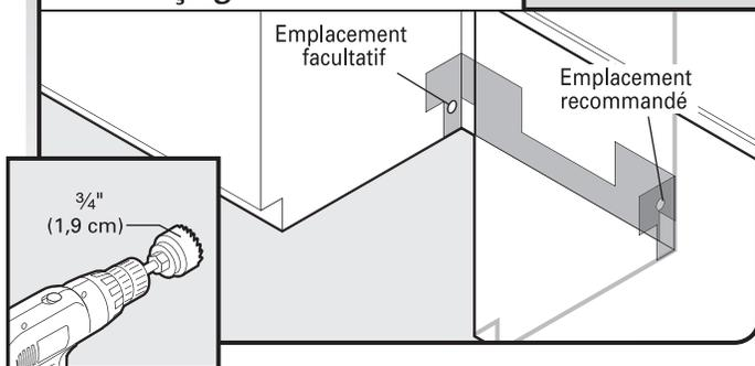
Percer un trou de  $\frac{3}{4}$ " (1,9 cm) dans le côté droit de la paroi latérale ou arrière du placard.
