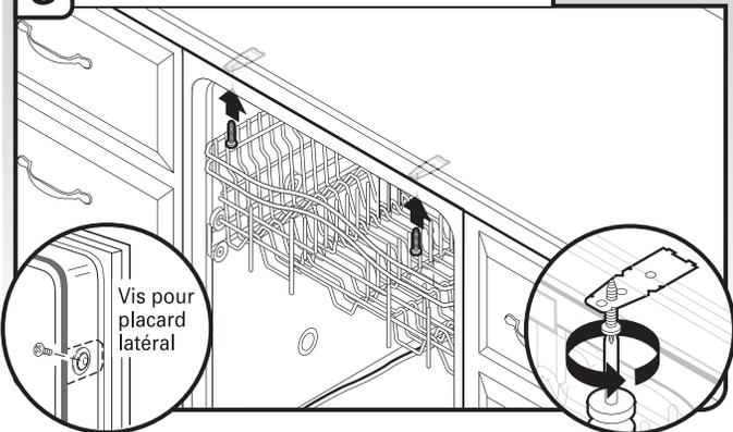
**REMARQUE :** Ne pas faire tomber de vis au fond du lave-vaisselle. Pour un montage latéral, pré-percer des avant-trous (avec un foret de 1/8") dans le placard avant d'installer les vis pour que le bois ne se fende pas.
