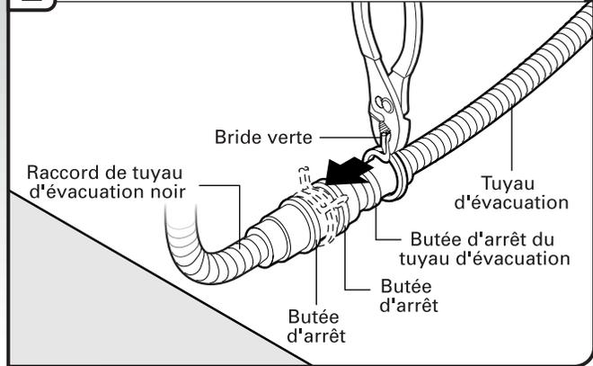
À l'aide d'une pince, ouvrir la petite bride de tuyau d'évacuation verte en la serrant et la glisser sur le connecteur, entre les butées.
