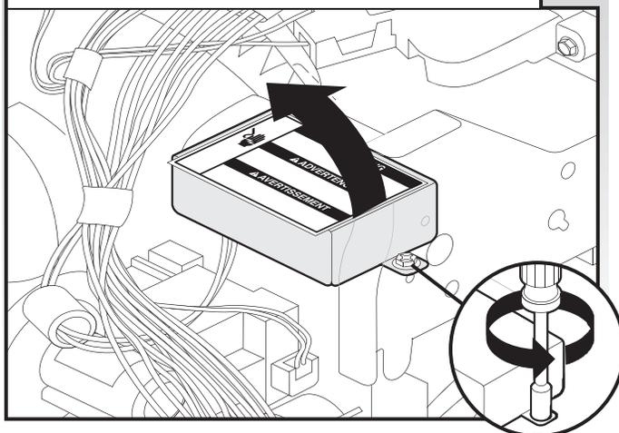
À l'aide d'une clé à douille, un tourne-écrou ou un tournevis Phillips de 1/4", ôter le couvercle du boîtier de connexion. Le conserver pour utilisation ultérieure.
