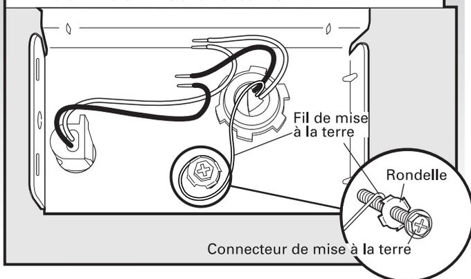
Former un crochet en U avec le conducteur nu de liaison à la terre. Enrouler le crochet du conducteur de liaison à la terre sur la vis de liaison à la terre et sous la rondelle (dans le sens horaire). Serrer fermement le connecteur de liaison à la terre.
