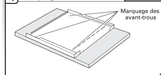
Marquer l'emplacement des quatre trous; ôter le panneau externe. Percer des avant-trous de  $\frac{3}{32}$ " (2,4 mm) à  $\frac{1}{2}$ " (13 mm) de profondeur dans le panneau personnalisé acheté par le client. Placer le panneau externe à l'arrière du panneau personnalisé acheté par le client; aligner les trous.
