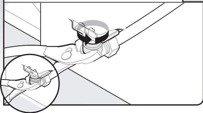
S'assurer que la rondelle de caoutchouc est correctement installée dans le raccord. Enfiler le raccord de  $\frac{3}{4}$ " vers le haut jusqu'à la valve et serrer à la main afin d'éviter de fausser le filetage. Serrer à la main jusqu'à ce que le raccord soit serré. À l'aide d'une pince, vérifier l'étanchéité du raccord.  $\frac{1}{4}$  à  $\frac{1}{2}$  tour supplémentaire peut s'avérer nécessaire pour créer l'étanchéité du joint de caoutchouc.
