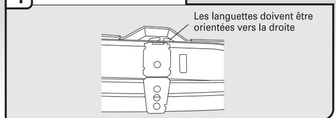
Retirer les brides de l'emballage et les insérer dans les fentes ouvertes sur les côtés supérieurs droit et gauche du collet du lave-vaisselle, tel qu'indiqué.
