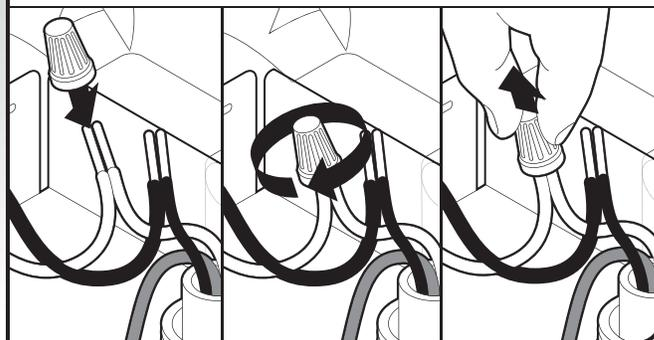
**REMARQUE :** Installer le connecteur de fils en le faisant pivoter. Tirer doucement sur les conducteurs pour vérifier qu'ils sont bien fixés.
