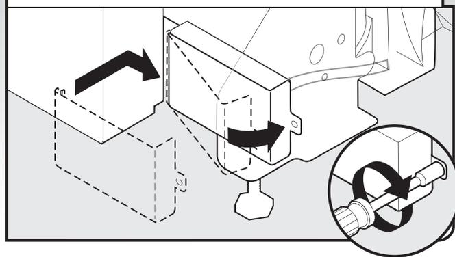
Placer les conducteurs à l'intérieur du boîtier de connexion. Insérer les languettes du côté gauche du couvercle. S'assurer que les fils sont bien logés à l'intérieur du boîtier. Fermer le couvercle tout en veillant à ne pas coincer de fils. Fixer le couvercle à l'aide d'un tourne-écrou de 1/4" et de la vis précédemment retirée.
