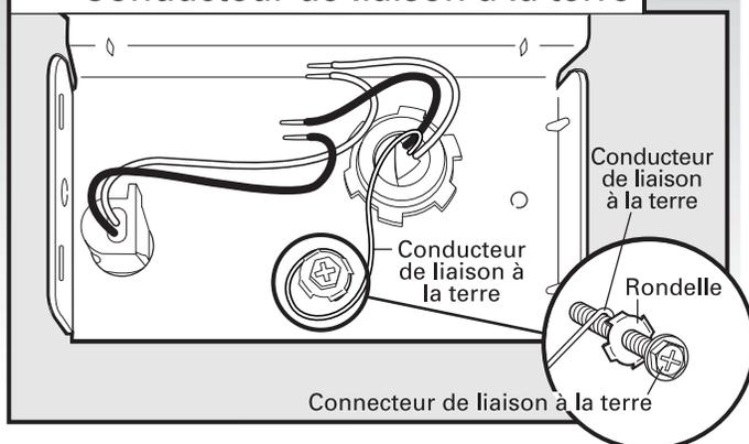
Ôter la vis verte de liaison à la terre et la placer à travers la borne en anneau de la vis verte de mise à la terre. Fixer à nouveau la vis verte et la serrer.
