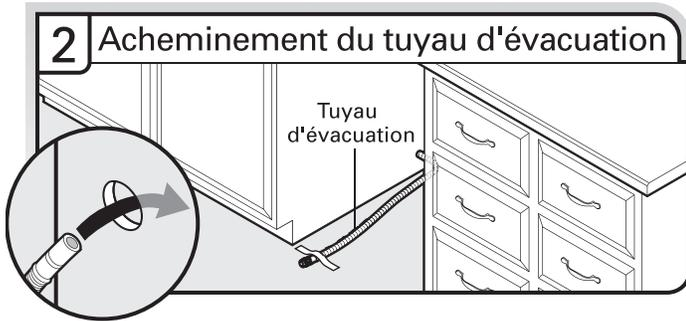
Insérer le tuyau d'évacuation tel qu'indiqué à travers le trou dans le placard et l'acheminer jusqu'au point de raccordement du tuyau d'évacuation (au centre de l'ouverture, à l'avant). Fixer le tuyau d'évacuation au plancher avec du ruban adhésif dans la zone indiquée. Cela l'empêchera de bouger lors de l'insertion du lave-vaisselle dans l'ouverture du placard.
