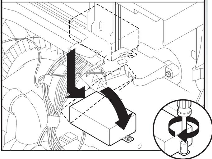
Placer les conducteurs à l'intérieur du boîtier de connexion. Insérer les languettes du côté gauche du couvercle. S'assurer que les fils sont bien logés à l'intérieur du boîtier. Fermer le couvercle tout en veillant à ne pas coincer de fils. Fixer le couvercle à l'aide d'un tourne-écrou de 1/4" et de la vis précédemment retirée.
