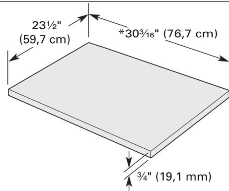
\* Cette dimensions est valable pour une bride de calage de 4" (10,2 cm). Si l'installation nécessite une bride de calage plus haute, régler la hauteur du panneau de bois en fonction. Pas recommandé pour les brides de calage supérieures à 6" (15,2 cm).
