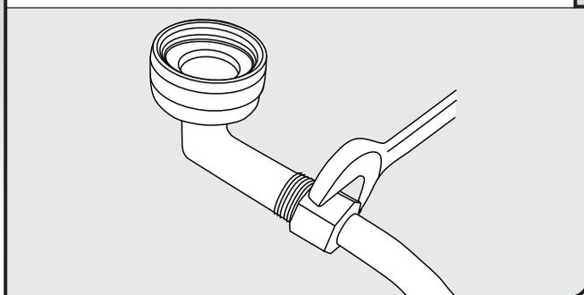
Raccorder le raccord de compression de  $\frac{3}{8}$ " à la canalisation d'alimentation en eau avant d'installer l'appareil dans l'ouverture découpée dans le placard. Le fixer de façon à ce que le raccord de  $\frac{3}{4}$ " soit orienté vers le haut, tel qu'illustré ci-dessous.
