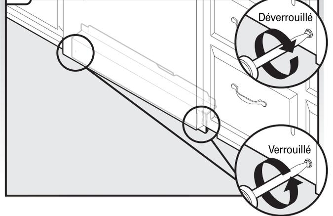
À l'aide d'un tournevis à lame plate, tourner les dispositifs de fixation d'un quart de tour pour les verrouiller. L'encoche du dispositif de verrouillage sera complètement à la verticale lorsqu'elle est correctement verrouillée.
