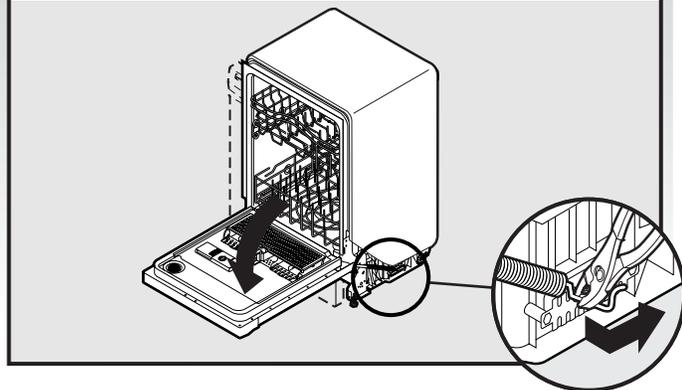
Lorsque la porte est déverrouillée, si elle s'ouvre d'elle-même, déplacer le tendeur vers un trou numéroté supérieur et replacer la vis. Fixer à nouveau le ressort de la porte au pied arrière.
