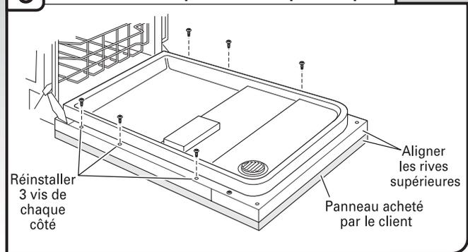
Installer le panneau sur la porte en réinstallant les trois vis de chaque côté; ne pas les serrer complètement. Ceci tiendra le panneau en place sur le cadre de la porte.
