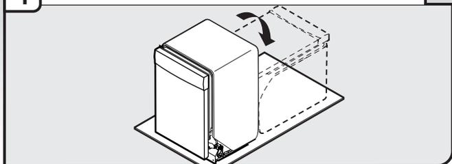
**Conseil utile :** Placer un carton sous le lave-vaisselle jusqu'à son installation dans l'ouverture d'encastrement du placard pour éviter d'endommager le revêtement de sol. Afin d'éviter d'érafler le panneau de porte, ne pas s'en servir comme planche de travail sans l'avoir recouvert d'une serviette au préalable.
