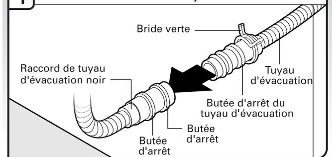
Placer une serviette sous le tuyau d'évacuation pour récupérer l'eau restée dans le tuyau d'évacuation. Placer la petite bride verte pour tuyau d'évacuation sur la petite extrémité du tuyau d'évacuation. Enfoncer le tuyau d'évacuation neuf dans le connecteur noir de tuyau d'évacuation jusqu'à la butée d'arrêt du tuyau d'évacuation.
