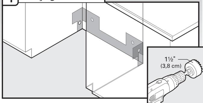
Si nécessaire, percer un trou de 1 1/2" (3,8 cm) de diamètre dans la paroi du placard ou l'arrière de l'ouverture la plus proche de l'évier.
