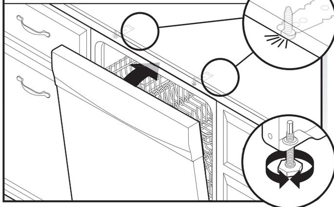
Vérifier qu'il n'y a aucun contact entre le sommet de la porte et les vis, les brides ou le plan de travail. Régler les pieds de nivellement le cas échéant.
