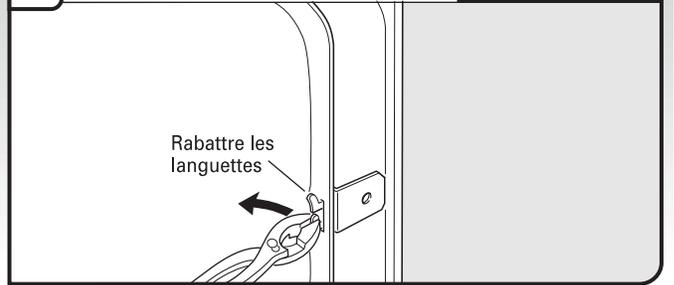
Enfoncer la bride dans la fente sur le côté du lave-vaisselle et replier la languette vers le côté du lave-vaisselle afin de maintenir la bride en place. Répéter cette étape pour l'autre côté du lave-vaisselle.
