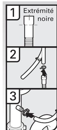
1. Raccorder l'extrémité noire du tuyau d'évacuation au dispositif de brise-siphon et couper si nécessaire. **REMARQUE :** Ne pas couper la section ondulée.
