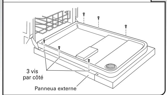
Mettre le panneau externe de côté avec précaution. Placer le panneau personnalisé acheté par le client orienté vers le bas sur une surface couverte et lisse.
