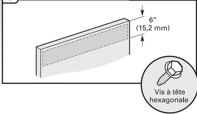
Installer le panneau externe sur l'arrière du panneau personnalisé à l'aide des quatre vis à tête hexagonales n°10-16 x 3/8" fournies avec le sachet de documentation. Installer la poignée. La poignée doit être centrée sur l'avant du panneau personnalisé fourni par le client dans la zone illustrée.
