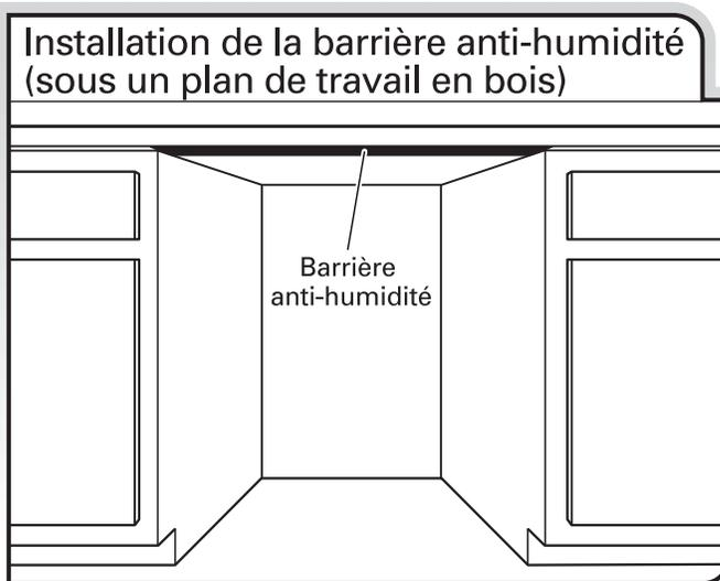
1. Veiller à ce que la zone se trouvant sous le placard soit propre et sèche avant d'installer la barrière antihumidité.
