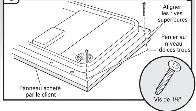
Installer les deux vis n°8-18 x 1 1/4", provenant du sachet de documentation, dans les coins supérieurs du panneau interne. Serrer les six vis latérales réinstallées à l'étape 6.
