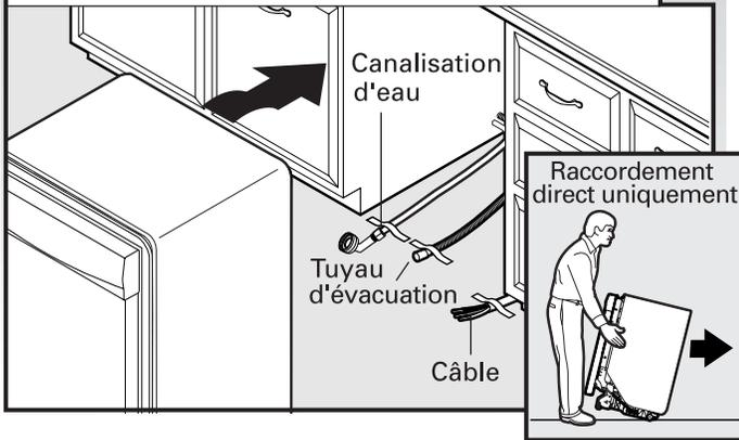
**IMPORTANT :** Vérifier que le câblage est bien installé. Saisir les côtés du lave-vaisselle par les rebords du panneau de porte. Incliner le lave-vaisselle vers l'arrière sur ses roulettes et approcher l'appareil de l'ouverture dans le placard.
