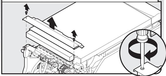
À l'aide d'un tournevis à lame plate, tourner les dispositifs de fixation d'un quart de tour pour les déverrouiller. Retirer le panneau. Ne pas retirer la fiche technique du panneau d'accès.
