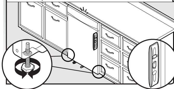
Vérifier que chaque pied de réglage de l'aplomb est fermement en appui sur le sol. Fermer et verrouiller la porte; placer un niveau contre le panneau avant. Vérifier que le lave-vaisselle est centré de l'avant vers l'arrière dans l'ouverture. Si nécessaire, régler le pied de nivellement jusqu'à ce que le lave-vaisselle soit d'aplomb. Répéter ces opérations pour l'autre côté du lave-vaisselle.
