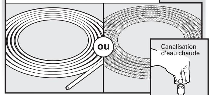
Mesurer la longueur totale de la canalisation de cuivre ou de la canalisation d'arrivée d'eau flexible à tresse d'acier. Fixer la canalisation d'eau chaude à l'aide d'une configuration de raccordement qui soit conforme à tous les codes et règlements locaux. La canalisation d'eau raccordée au lave-vaisselle doit comporter un robinet d'arrêt manuel.
