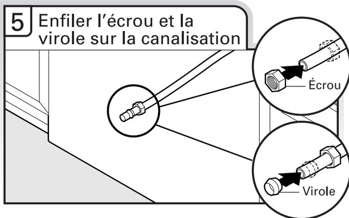
Canalisation en cuivre uniquement : Enfiler l'écrou puis la virole sur la canalisation de cuivre, sur environ 1" (2,5 cm).
