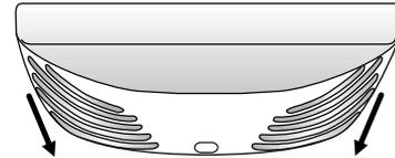
3. Remplacer la ou les ampoule(s) grillée(s) par une ampoule électrique pour appareil ménager n'excédant pas 40 watts.
