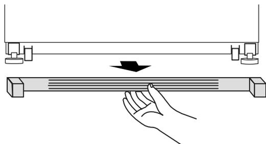
2. Déplacer le réfrigérateur jusqu'à sa position de service finale.
