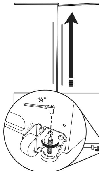
6. S'assurer que le réfrigérateur est stable. Si le réfrigérateur semble instable ou qu'il roule vers l'avant lorsqu'on ouvre la porte ou le tiroir, ajuster les vis de nivellement. À l'aide d'un tourne-écrou à tête hexagonale de 1/4", tourner les vis de nivellement dans le sens horaire de chaque côté jusqu'à ce que les pieds de nivellement soient en contact ferme avec le plancher.
