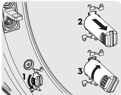
Para eliminar la sujeción, apriete la sujeción hacia dentro y gírela hasta la posición de bloqueo.
