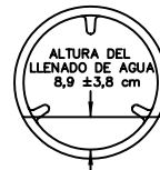
SIN CARGA, POSICIÓN DE ARRANQUE DEL CICLO PARA TALAS DE PLANCHADO PERMANENTE.
