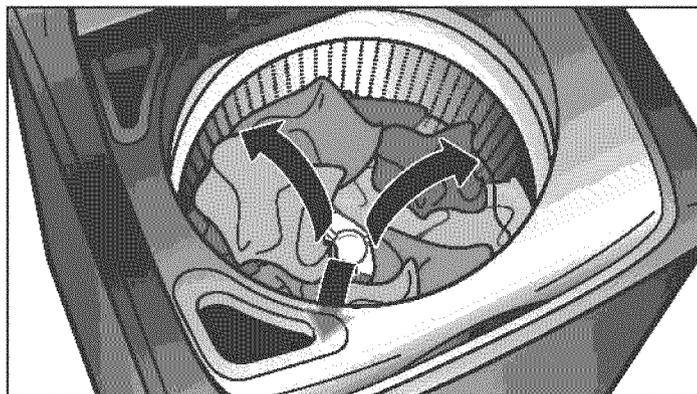
L'impulseur déplace la charge dans l'eau en utilisant moins d'eau et d'énergie qu'une laveuse traditionnelle de type agitateur.
