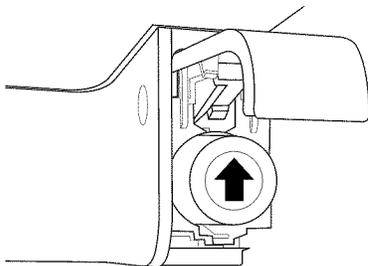
1. Repérer le filtre à eau situé dans le coin supérieur droit du compartiment de réfrigération.
