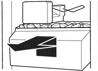
4. Replacer le bac à glaçons en le poussant complètement sinon le distributeur ne fonctionnera pas.
