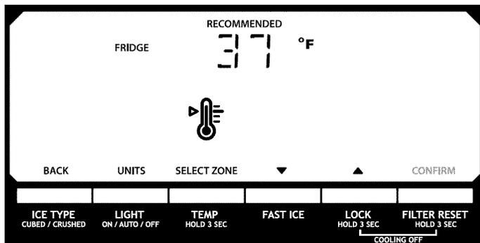
**REMARQUE :** Pour visualiser les températures en Celsius, appuyer sur la touche LIGHT (éclairage) lorsque le mode de réglage est activé. Pour revenir au mode d'affichage en Fahrenheit, appuyer de nouveau sur LIGHT.
