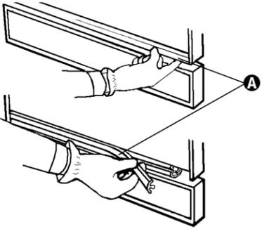
Wear gloves and handle panels carefully. Insert finger under one end of retainer **A** and pull towards you in a peeling action. Set retainer aside. Porter des gants et manipuler les panneaux prudemment. Insérer le doigt sous une extrémité de la moulure de retenue **A**, puis tirer la moulure de retenue vers soi et la mettre de côté.
