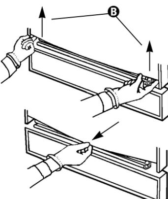
Lift door panel(s) at outer edges **B**. Use one hand to bow bottom of panel(s). Remove panel(s). **Do Not remove spacer.** Soulever chaque extrémité **B** du panneau de porte. À l'aide d'une main, cintrer le panneau inférieur. Enlever le panneau. **Ne pas enlever la plaque d'espacement.**
