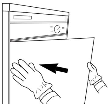
Insert one side of door panel(s), with desired color facing out, into one side of door frame. Insérer un côté du panneau de porte dans l'encadrement de la porte, la couleur désirée étant orientée vers l'extérieur.
