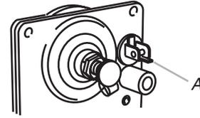
A. Robinet d'arrêt du détendeur
