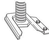
3. Dans le cas de l'installation de la cuisinière dans une résidence mobile, on doit fixer la cuisinière au plancher. Toute méthode de fixation de la cuisinière au plancher est adéquate dans la mesure où elle est conforme aux normes mentionnées à la section "Exigences de l'emplacement d'installation".
