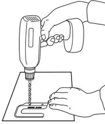
Pour monter la bride antibasculement sur un plancher en béton ou en céramique, utiliser un foret à maçonnerie de  $\frac{3}{16}$ " (4,8 mm) pour percer 2 trous aux emplacements indiqués sur le gabarit de la bride. Enlever le gabarit du sol.
