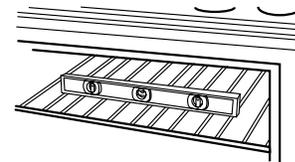
Si la cuisinière n'est pas d'aplomb, tirer la cuisinière vers l'avant pour dégager le pied arrière de la bride antibasculement. Avec une clé à cliquet de  $\frac{3}{8}$ " et une pince multiprise, ajuster les pieds de réglage de l'aplomb vers le haut ou vers le bas pour obtenir un parfait aplomb de la cuisinière. Pousser de nouveau la cuisinière jusqu'à sa position finale. Vérifier que le pied arrière est correctement engagé dans la bride antibasculement.
