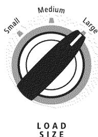
Sélectionner le réglage de volume de charge le plus adapté à votre charge. Small (petite) ajoute une faible quantité d'eau pour les charges plus petites et Large (grande) ajoute la quantité d'eau la plus importante pour les grandes charges ou les charges volumineuses. Les articles doivent pouvoir se déplacer librement.
