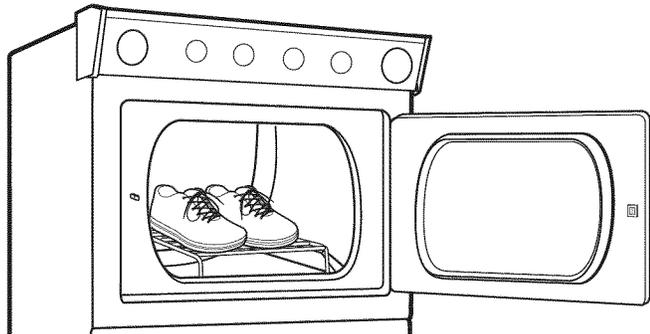
3. Placer les articles mouillés sur la grille de séchage. Laisser suffisamment d'espace entre les articles pour permettre à l'air de circuler. Le tambour tourne, mais la grille ne bouge pas. Veiller à ce que les articles ne pendent pas par-dessus les bords de la grille de séchage ou entre les barreaux de la grille.
