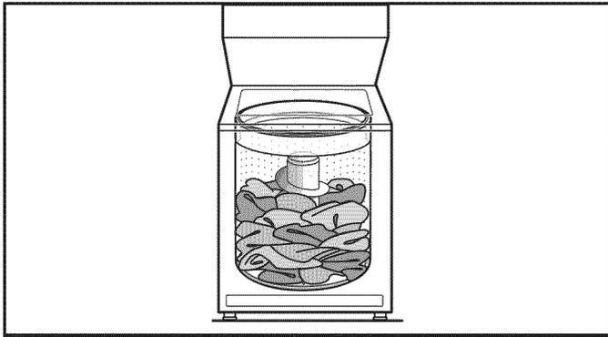
**IMPORTANT :** Ne pas tasser les articles ou les pousser dans la laveuse. Les articles doivent pouvoir se déplacer librement pour un nettoyage optimal et pour réduire le froissement et l'emmêlement.
