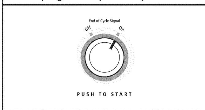
Votre sècheuse peut être munie d'un signal de fin de programme (End of Cycle signal). Le signal est utile lorsque vous faites sécher des articles qui doivent être retirés de la sècheuse aussitôt qu'elle s'arrête. Le signal de fin de programme fait partie du bouton d'enfoncer pour mettre en marche et peut être sélectionné. Tourner le bouton PUSH TO START (enfoncer pour mettre en marche) à ON (marche) ou OFF (arrêt). Le signal sera entendu seulement si le bouton sélecteur est réglé à ON.
