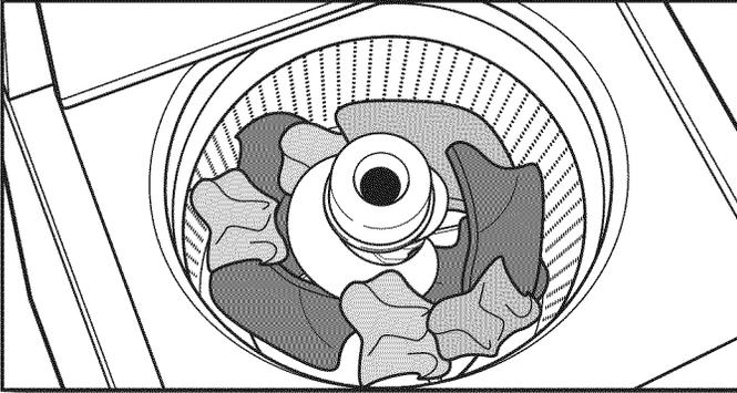
Charger les vêtements sans les tasser et de façon uniforme le long de la paroi du panier. Pour de meilleurs résultats, ne pas remplir au-delà de la hauteur maximale de charge recommandée. Ne pas enrouler de grands articles tels des draps autour de l'agitateur; les charger sans les tasser le long de la paroi du panier. Essayer de mélanger différents types d'articles pour réduire l'emmêlement.
