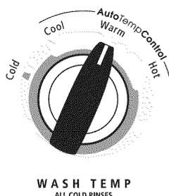
Après avoir sélectionné un programme, sélectionner la température de lavage désirée en tournant le bouton de température de lavage sur le réglage adapté à la charge à laver. Tous les rinçages se font à la température de l'eau froide du robinet.
