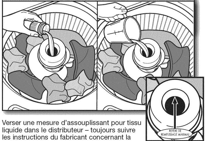
Verser une mesure d'assouplissant pour tissu liquide dans le distributeur – toujours suivre les instructions du fabricant concernant la dose d'assouplissant pour tissu à utiliser en fonction de la taille de la charge.
