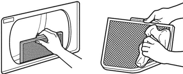
Nettoyer le filtre à charpie avant chaque charge. Enlever le filtre à charpie en le tirant tout droit vers le haut. Enlever la charpie du filtre en la roulant avec les doigts. Ne pas rincer ni laver le filtre pour enlever la charpie. Remettre le filtre à charpie fermement en place.
