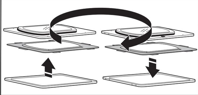
Gire la puerta exterior 180° y colóquela de nuevo sobre la puerta interior. Asegúrese de mantener el espaciador de cartón centrado entre las puertas. Vuelva a sujetar el panel exterior al panel interior de la puerta, de modo que la manija quede en el lado en donde recién se han quitado las bisagras. Inserte los 4 tornillos de la puerta.
