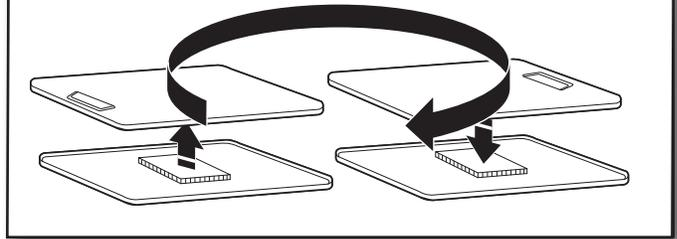
Gire la puerta exterior 180° y colóquela de nuevo sobre la puerta interior. Asegúrese de mantener el espaciador de cartón centrado entre las puertas. Vuelva a sujetar el panel exterior al panel interior de la puerta, de modo que la manija quede en el lado en donde recién se han quitado las bisagras. Inserte los 6 tornillos de la puerta.
