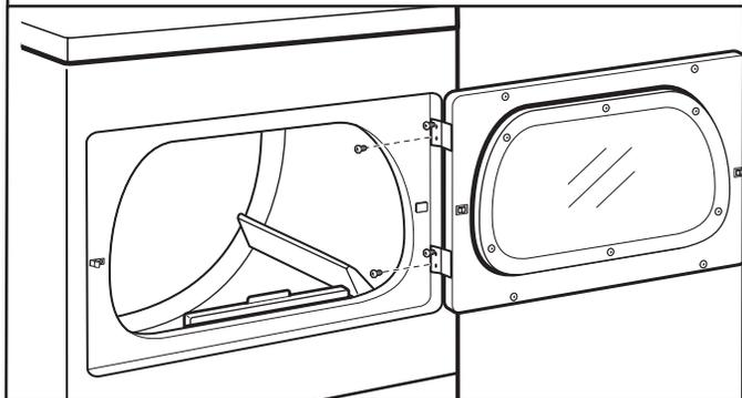
Abra la puerta de la secadora. Extraiga los tornillos inferiores de las bisagras del lado de la carcasa. Afloje (no extraiga) los tornillos superiores de las bisagras del lado de la carcasa de la secadora.
