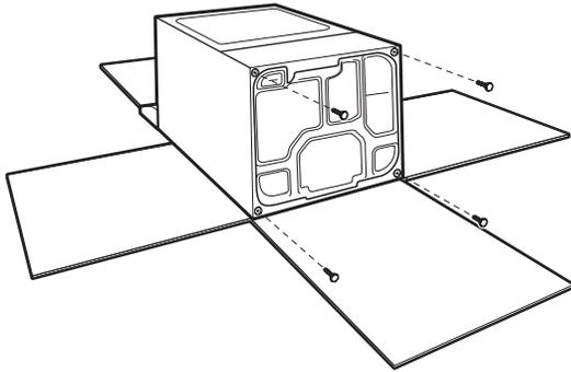
Para evitar daños en el piso, use un pedazo de cartón grande y plano de la caja de la secadora; colóquelo debajo de todo el borde posterior de la secadora. Agarre con firmeza el cuerpo de la secadora (no el panel de la consola) y coloque la secadora suavemente sobre el cartón.
