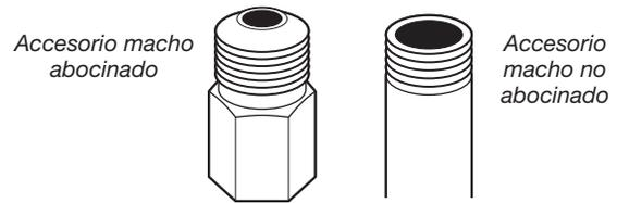
Quite la tapa roja del tubo de gas. Utilizando una llave de tuercas para ajustar, conecte el suministro de gas a la secadora. Use compuesto para unión de tubos en las roscas de todos los accesorios macho no abocinados. Si se usa tubería flexible de metal, asegúrese de que no hayan partes retorcidas.
