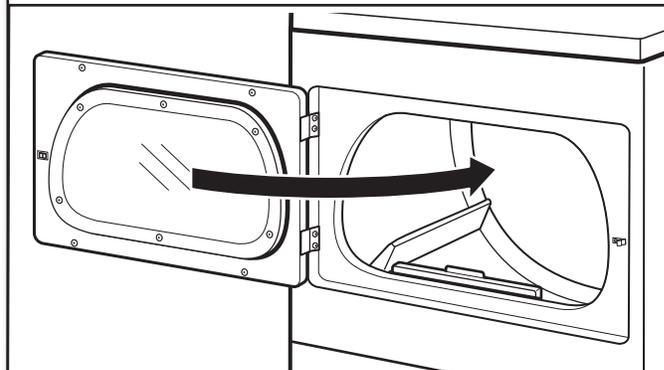
Cierre la puerta y asegúrese de que el tope de la misma esté alineado con el seguro de la puerta. Si es necesario, deslice el seguro de la puerta hacia la izquierda o derecha dentro de la ranura a fin de ajustar la alineación.
