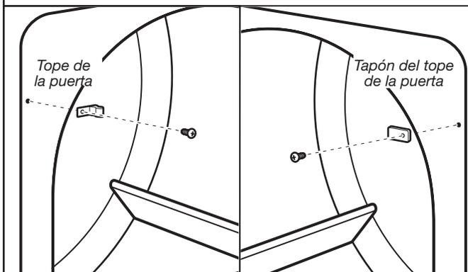
Saque el tope de la puerta y el tapón del tope de la puerta del gabinete de la secadora. Inserte el tope de la puerta en el orificio del tapón del tope de la puerta y asegúrelo con un tornillo. Inserte el tapón del tope de la puerta en el orificio del tope original y asegúrelo con un tornillo.
