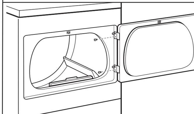
Abra la puerta de la secadora. Extraiga los tornillos inferiores de las bisagras del lado de la carcasa. Afloje (no extraiga) los tornillos superiores de las bisagras del lado de la carcasa de la secadora.
