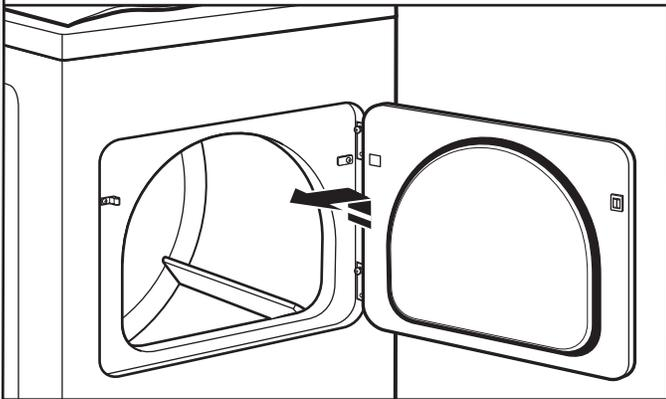
Levante la puerta hasta que los tornillos superiores de la carcasa estén en la parte grande de la ranura de la bisagra. Jale la puerta hacia adelante para separarla de los tornillos. Coloque la puerta (con el lado de la manija hacia arriba) encima de la secadora. Extraiga los tornillos superiores de la carcasa de la secadora.
