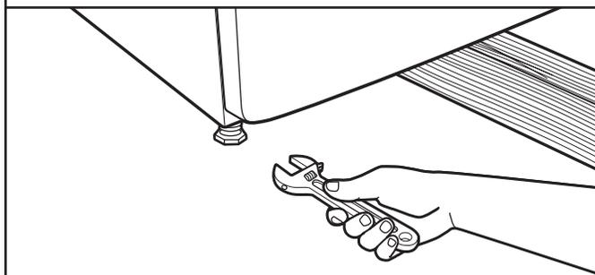
Si la secadora no está nivelada, levántela colocando un bloque de madera debajo de la misma, use una llave de tuercas para regular las patas hacia arriba o hacia abajo y revise nuevamente si está nivelada. Una vez que las patas estén niveladas, cerciórese de que las cuatro patas estén ajustadas contra el suelo antes de apretarlas.
