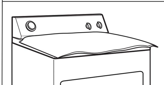
Coloque una toalla encima de la secadora para evitar dañar la superficie
