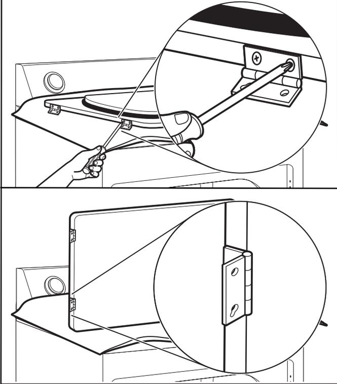
Vuelva a sujetar las bisagras de la puerta a la puerta de la secadora, de manera que el orificio más grande quede en la parte inferior de la bisagra.
