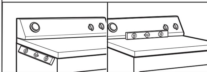
Revise la nivelación de la secadora de lado a lado. Repita el procedimiento de adelante hacia atrás.
