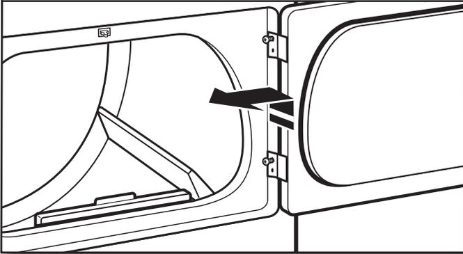
Levante la puerta hasta que los tornillos superiores de la carcasa de la secadora estén en la parte grande de la ranura de la bisagra. Jale la puerta hacia adelante para separarla de los tornillos. Coloque la puerta (con el lado de la manija hacia arriba) encima de la secadora. Extraiga los tornillos superiores de la carcasa de la secadora.
