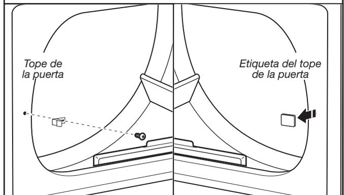
Saque el tope de la puerta y la etiqueta del tope de la puerta de la carcasa de la secadora. Inserte el tope de la puerta en el orificio de donde se retiró la etiqueta y asegúrelo con un tornillo. Cubra el orificio original del tope de la puerta con la etiqueta del tope y presiónela firmemente en su lugar.
