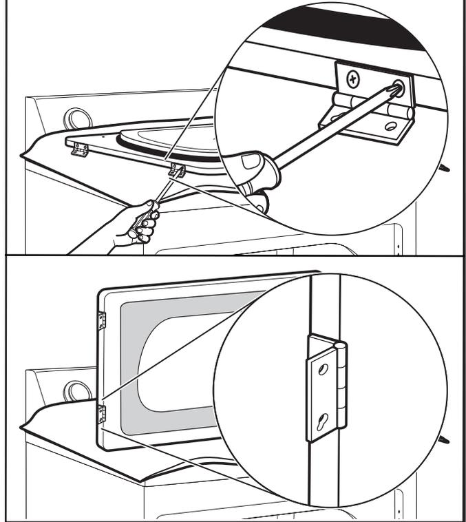
Vuelva a sujetar las bisagras de la puerta a la puerta de la secadora, de manera que el orificio más grande quede en la parte inferior de la bisagra.
