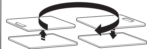
Gire la puerta exterior 180° y colóquela de nuevo sobre la puerta interior. Vuelva a sujetar el panel exterior al panel interior de la puerta, de modo que la manija quede en el lado en donde recién se han quitado las bisagras. Inserte los 4 tornillos de la puerta.
