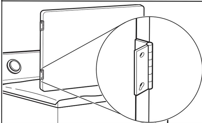
Vuelva a sujetar las bisagras de la puerta a la puerta de la secadora, de manera que el orificio más grande quede en la parte inferior de la bisagra.
