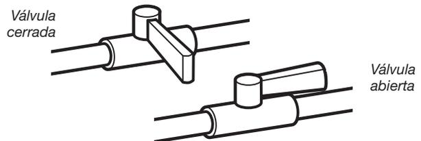
Abra la válvula de cierre en la línea de suministro; la válvula está abierta cuando la manija está paralela al tubo de gas. Luego pruebe todas las conexiones aplicando con un cepillo una solución aprobada para detección de fugas que no sea corrosiva. Se observarán burbujas si hay fugas. Tape cualquier fuga que encuentre.
