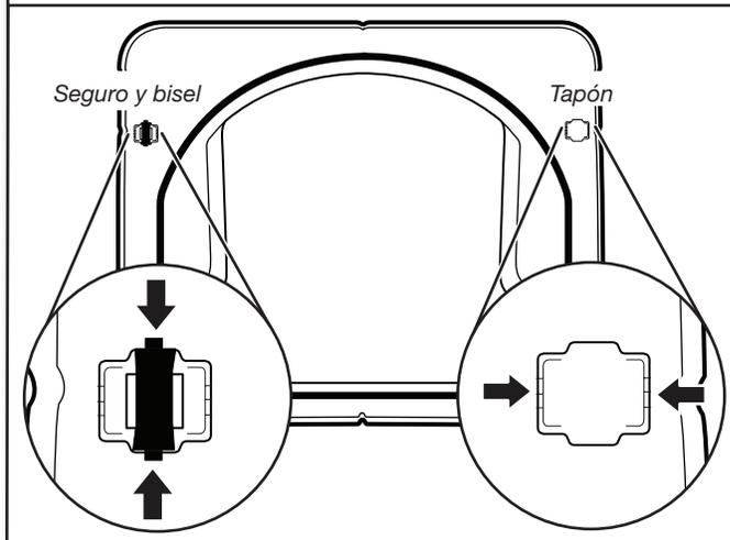
Quite el seguro, el bisel y el tapón de la parte posterior de la puerta interior apretando y jalándolos/empujándolos. Coloque el seguro, el bisel y el tapón de la puerta en los lados opuestos a los que se encontraban.
