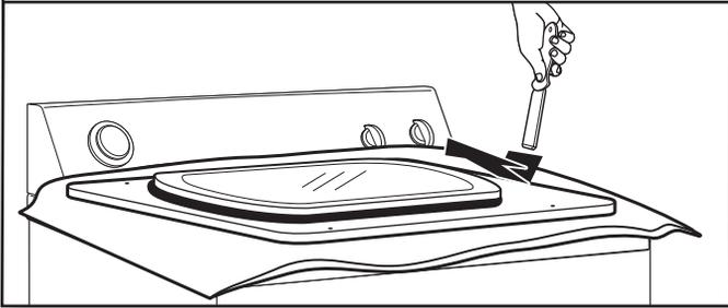
Sosteniendo la puerta sobre la toalla encima de la secadora, haga palanca a la puerta interior y levántela para separarla de la puerta exterior.
