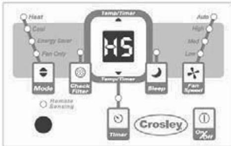
Si la pantalla muestra "HS", hubo falla de un sensor. Póngase en contacto con el Centro de Asistencia Técnica Autorizado Frigidaire.
