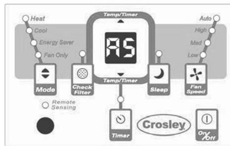
Si la pantalla muestra "AS", hubo falla de un sensor. Póngase en contacto con el Centro de Asistencia Técnica Autorizado Frigidaire.
