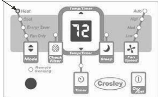
**Nota:** Puede usar esta característica con cualquier combinación de modos de Velocidades del ventilador, Temporizador o Sleep. En el modo "Calor" el ventilador funcionará sin interrupción mientras se necesite calor. La temperatura se mantendrá automáticamente entre 55°F (13°C) y 80°F (27°C). Cuando se alcance la temperatura ambiente, el ventilador se desactivará y activará para circular y comprobar el aire ambiente.
