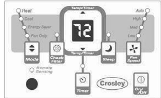
Nota: Presione o mantenga presionado el botón arriba (▲) o abajo (▼) hasta que la temperatura deseada se visualice en pantalla. Esta temperatura será automáticamente mantenida en cualquier lugar entre los 60°F (16°C) y 90°F (32°C). La temperatura se mantendrá automáticamente alrededor de 55°F (13°C) y 0°F (27°C) en el modo calefacción Si quiere que el visualizador muestre la temperatura actual de la habitación. Vea la sección "Operar Sólo el Ventilador" página 7
