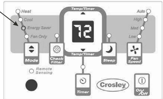
**Nota:** En este modo, el ventilador continuará funcionando por unos 3 minutos más luego que el compresor se apague. El ventilador luego circula por 2 minutos en intervalos de 10 minutos hasta que la temperatura ambiente esté sobre la temperatura ajustada, en ese momento la unidad volverá a encenderse.
