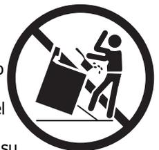
En el caso de los modelos equipados con un cajón calentador o con un horno inferior, sostenga el borde superior trasero de la estufa e intente con cuidado inclinarla hacia adelante. Consulte las instrucciones de instalación para montar correctamente el soporte antivuelco.
