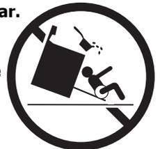
Para reducir el riesgo de vuelco, la estufa debe fijarse con los soportes antivuelco debidamente instalados que se proporcionan con la estufa. Para comprobar que el soporte está instalado correctamente, verifique visualmente (retirando el panel delantero inferior o el cajón de almacenamiento de la estufa) que el tornillo nivelador trasero esté en su lugar y que esté debidamente fijado en y mediante el soporte antivuelco.
