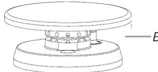
5. Allumer le brûleur. Si le brûleur ne s'allume pas, vérifier l'alignement du chapeau. Si le brûleur ne s'allume toujours pas, ne pas réparer vous-même le brûleur scellé. Contacter un technicien de réparation qualifié.
