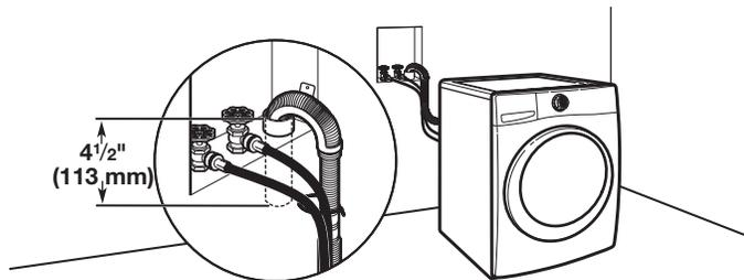
Vea los requisitos para el sistema de desagüe de tubo vertical de piso.
