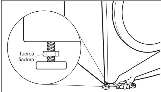
Cuando la lavadora esté nivelada, use una llave de boca o una llave ajustable de 9/16" ó 14 mm para girar las tuercas fijadoras en las patas hacia la izquierda, apretándolas contra el gabinete de la lavadora.
