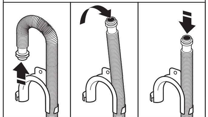
Para las instalaciones con desagüe por el piso, necesitará quitar el molde de la manguera de desagüe del extremo de la misma. Puede ser que necesite piezas adicionales con instrucciones por separado. Vea "Piezas alternativas".
