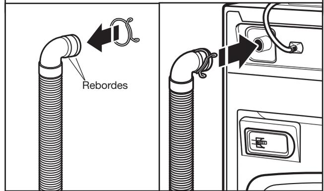
Si la abrazadera no está puesta sobre el codo de la manguera de desagüe, deslícela sobre el extremo de la manguera centrándola entre los rebordes, como se muestra. Apriete la abrazadera con pinzas y deslice el extremo en forma de codo de la manguera de desagüe sobre el puerto de desagüe. Asegúrelo con la abrazadera.
