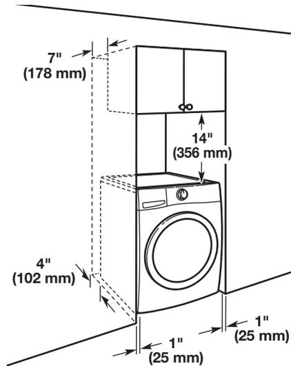
**Instalación en zona empotrada o en clóset (lavadora y secadora apiladas):**
