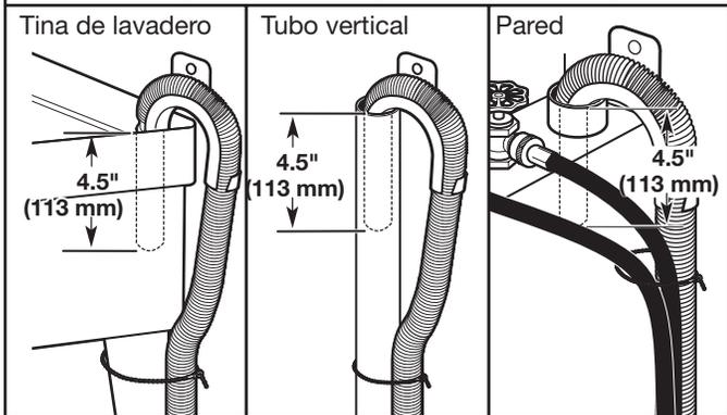
Asegure la manguera de desagüe a la pata del lavadero, al tubo vertical o a las mangueras de entrada para el tubo vertical de pared, utilizando el fleje de atadura rebordeado.
