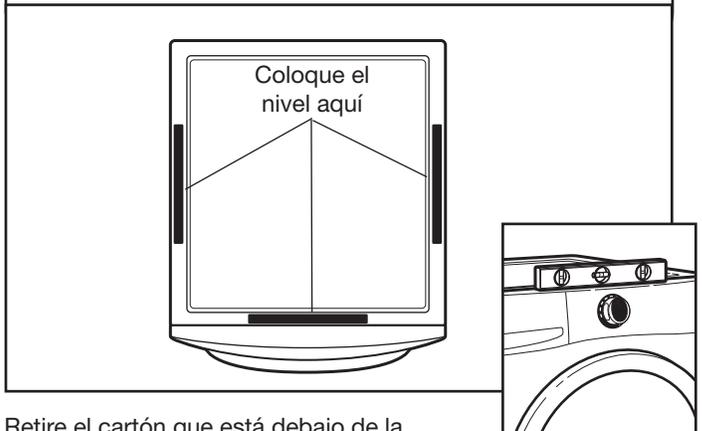
Retire el cartón que está debajo de la lavadora. Coloque un nivel en los bordes superiores de la lavadora, revisando cada lado y el frente. Si la lavadora no está nivelada, inclínela y ajuste las patas hacia arriba o hacia abajo, como se muestra en los pasos 17 y 18, repitiendo si es necesario.
