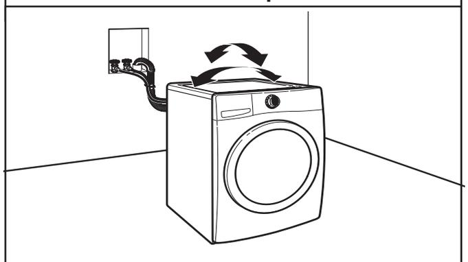
Sujete la lavadora de la parte superior y balancéela de atrás hacia delante, asegurándose de que las 4 patas estén firmes en el piso. Repítalo, balanceando la lavadora de un lado al otro. Si se balancea la lavadora, vaya al paso 17 y ajuste las patas niveladoras. Si las cuatro patas hacen contacto firme con el piso, vaya al paso 18.
