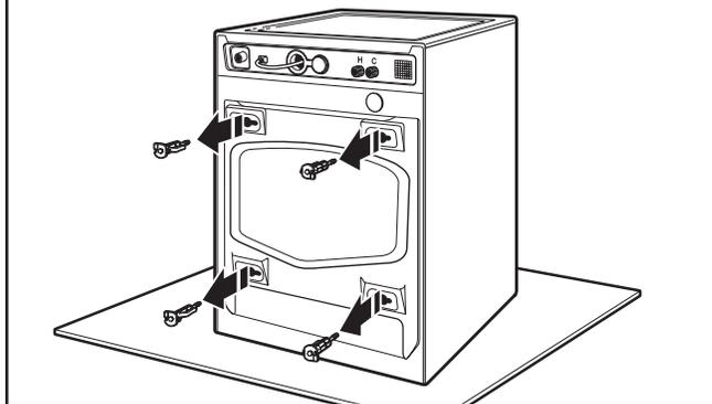
Afloje los pernos con una llave de tuercas de 1/2" (13 mm). Deslice cada perno y el espaciador hacia el centro del orificio. Jale los pernos y los espaciadores de plástico de la parte posterior de la lavadora. Deshágase de los pernos y los espaciadores.
