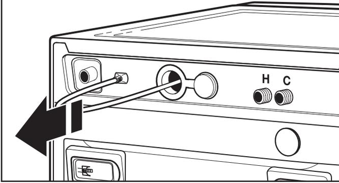
Jale el cable eléctrico a través de la abertura en el panel posterior y cierre el orificio con el tapón provisto.
