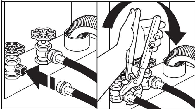
Cerchiórese de que las arandelas planas estén en ambos extremos de las mangueras de entrada. Sujete la manguera al grifo de agua caliente. Atornille el acoplamiento con la mano hasta que quede asentado en la lavadora. Use pinzas para apretar los acoplamientos dos tercios de vuelta adicional. Repita este paso con la segunda manguera para el grifo de agua fría.
