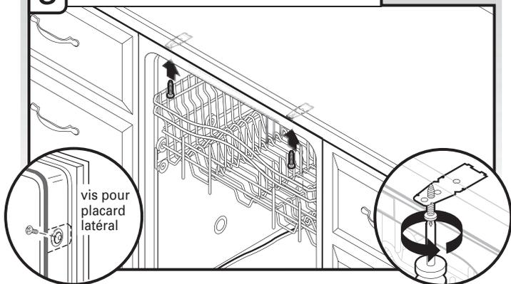
**REMARQUE :** Ne pas faire tomber de vis au fond du lave-vaisselle. Pour un montage latéral, pré-percer des avant-trous (avec un foret de 1/8") dans le placard avant d'installer les vis pour que le bois ne se fende pas.
