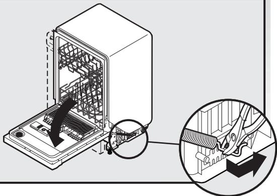
Lorsque la porte est déverrouillée, si elle s'ouvre d'elle-même, déplacer le tendeur vers un trou numéroté supérieur et replacer la vis. Fixer à nouveau le ressort de la porte au pied arrière.
