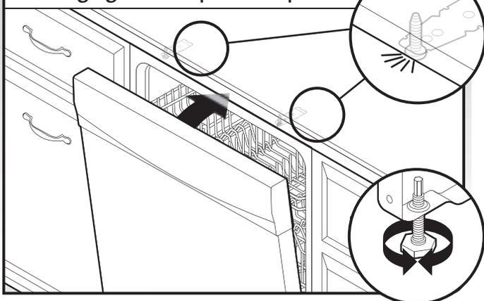
Vérifier qu'il n'y a aucun contact entre le sommet de la porte et les vis, les brides ou le plan de travail. Régler les pieds de nivellement le cas échéant.
