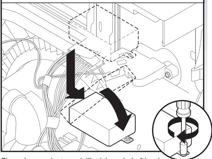
Placer les conducteurs à l'intérieur du boîtier de connexion. Insérer les languettes du côté gauche du couvercle. S'assurer que les fils sont bien logés à l'intérieur du boîtier. Fermer le couvercle tout en veillant à ne pas coincer de fils. Fixer le couvercle à l'aide d'un tourne-écrou de ¼" et de la vis précédemment retirée.
