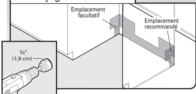
Perçer un trou de  $\frac{3}{4}$ " (1,9 cm) dans le côté droit de la paroi latérale ou arrière du placard. Voir les dimensions du produit et de l'ouverture d'encastrement du placard.
