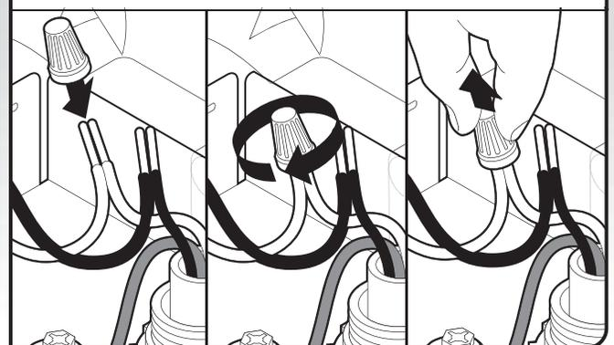
**REMARQUE :** Installer le connecteur de fils en le faisant pivoter. Tirer doucement sur les conducteurs pour vérifier qu'ils sont bien fixés.
