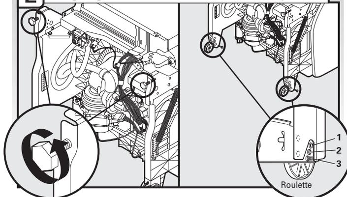
Régler les deux pieds de nivellement à la même hauteur. Placer les roues à la position requise déterminée à partir du "Tableau de réglage de la hauteur du lave-vaisselle".
