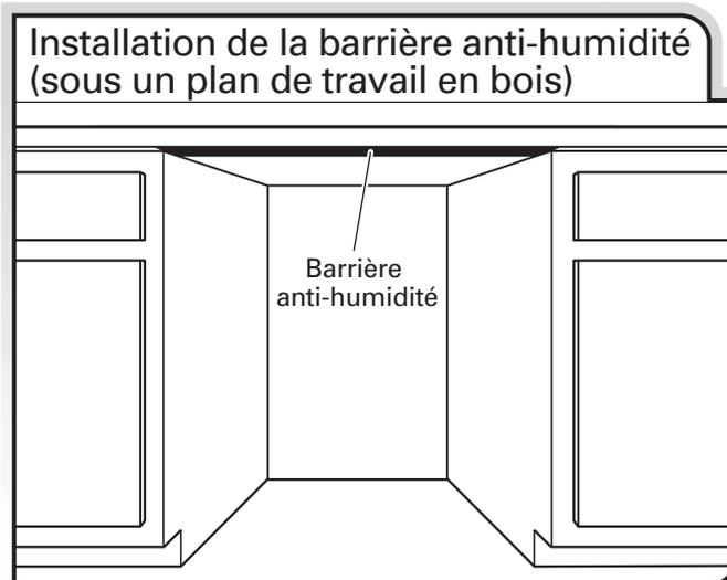
1. Veiller à ce que la zone se trouvant sous le placard soit propre et sèche avant d'installer la barrière anti-humidité.
