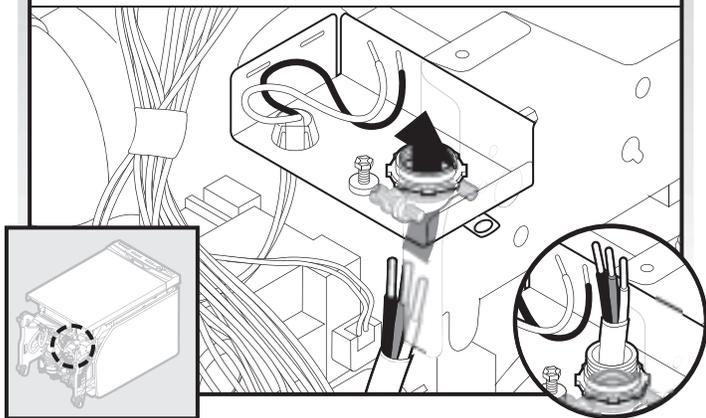
Acheminer le cordon d'alimentation de façon à ce qu'il ne touche pas la zone située entre le moteur du lave-vaisselle et la partie inférieure de la cuve du lave-vaisselle. Tirer le cordon pour l'acheminer à travers le serre-câble dans la boucle du boîtier de connexion. Prendre des précautions lors de l'installation ou de la dépose du lave-vaisselle afin de réduire le risque d'endommager le cordon d'alimentation.
