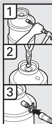
1. À l'aide d'un marteau et d'un tournevis, enfoncer le bouchon d'obturation dans le broyeur à déchets.
