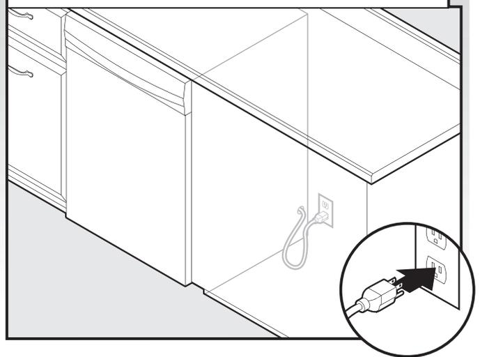
Brancher sur une prise de courant à 3 alvéoles reliée à la terre. Vérifier l'absence de tout contact entre le cordon d'alimentation et le moteur du lave-vaisselle ou la partie inférieure de la cuve du lave-vaisselle.
