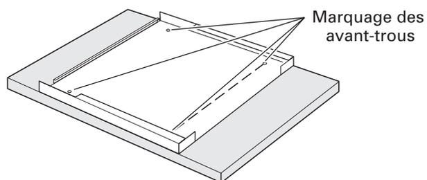
Marquer l'emplacement des quatre trous; ôter le panneau externe. Percer des avant-trous de  $\frac{3}{32}$ " à  $\frac{1}{2}$ " (13 mm) de profondeur dans le panneau personnalisé acheté par le client. Placer le panneau externe à l'arrière du panneau personnalisé acheté par le client; aligner les trous.
