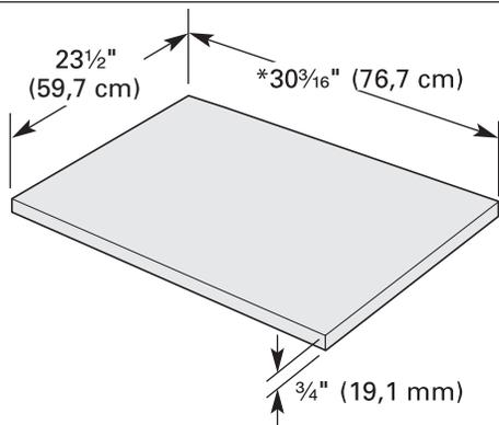
\* Cette dimension est valable pour une bride de calage de 4" (10,2 cm) - mesure prise sur meuble. Si l'installation nécessite une bride de calage plus haute, régler la hauteur du panneau de bois en fonction. Pas recommandé pour les brides de calage supérieures à 6" (15,2 cm).
