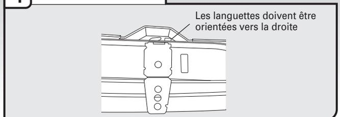
Sortir les brides de l'emballage et les placer dans les fentes ouvertes sur le côté droit et le côté gauche du haut du collet du lave-vaisselle (voir illustration).
