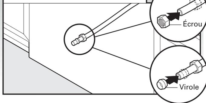
Canalisation en cuivre uniquement : Enfiler l'écrou puis la virole sur la canalisation de cuivre, sur environ 1" (2,5 cm).
