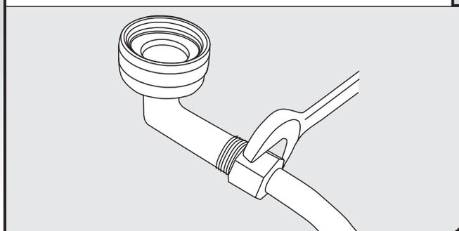
Raccorder le raccord de compression de  $\frac{3}{4}$ " à la canalisation d'alimentation en eau avant d'installer l'appareil dans l'ouverture découpée dans le placard. Le fixer de façon à ce que le raccord de  $\frac{3}{4}$ " soit orienté vers le haut, tel qu'illustré ci-dessous.
