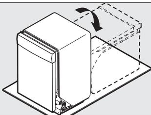
**Conseil utile :** Placer un carton sous le lave-vaisselle jusqu'à son installation dans l'ouverture d'encastrement du placard pour éviter d'endommager le revêtement de sol. Afin d'éviter d'érafler le panneau de porte, ne pas s'en servir comme planche de travail sans l'avoir recouvert d'une serviette au préalable.
