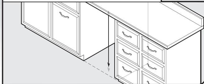
Mesurer la hauteur de l'ouverture d'encastrement du placard entre le dessous du plan de travail et le plancher, à l'emplacement d'installation du lave-vaisselle (la mesure doit être prise entre le point le plus bas depuis le dessous du plan de travail et le point le plus haut du plancher). Consulter le "Tableau de réglage de la hauteur du lave-vaisselle" pour la position des roulettes et le nombre de tours nécessaires.
