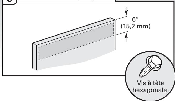
Installer le panneau externe sur l'arrière du panneau personnalisé fourni par le client à l'aide des quatre vis à tête hexagonales n°10-16 x 3/8" fournies avec le sachet de documentation. Installer la poignée. La poignée doit être centrée sur l'avant du panneau personnalisé fourni par le client dans la zone illustrée.
