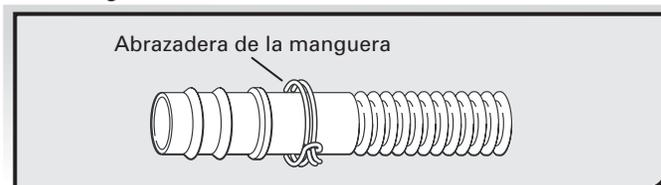
5. Empuje la manguera de desagüe contra el conector hasta el tope de la manguera de desagüe.
