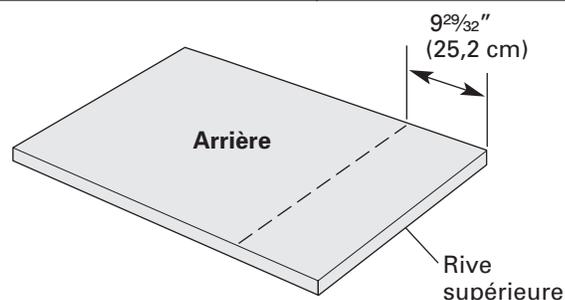
Mesurer  $9\frac{29}{32}$ " (25,2 cm) à partir de la rive supérieure et tracer un axe à l'arrière du panneau personnalisé acheté par le client. Positionner le panneau externe à l'arrière du panneau personnalisé acheté par le client tel qu'illustré, de façon à ce que les trous supérieurs dans le panneau externe se trouvent sur l'axe et que les deux panneaux soient centrés côte à côte.
