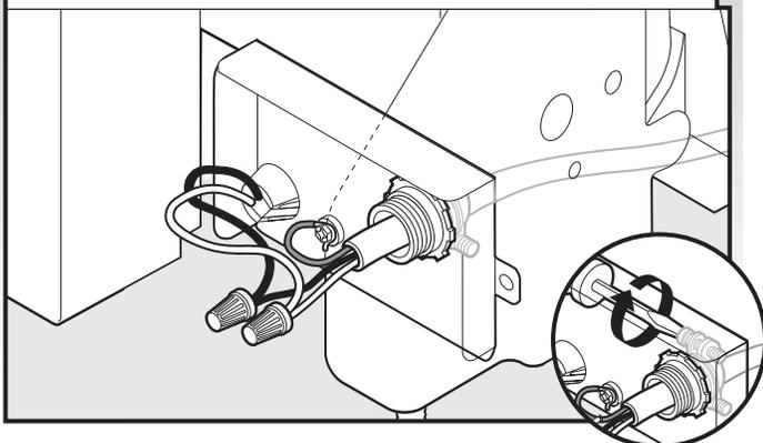
Resserrer les vis de serre-câble pour fixer le câble.
