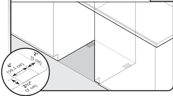
Planchers surélevés (la hauteur du plancher de la cuisine est supérieure à celle de l'ouverture d'encastrement du placard). Par exemple : Le carrelage du plancher de la cuisine n'arrive pas jusque dans l'ouverture du placard. Ajouter des cales selon le besoin dans la zone indiquée pour placer le lave-vaisselle à une hauteur maximale de 34" (86,4 cm) sous le plan de travail.
