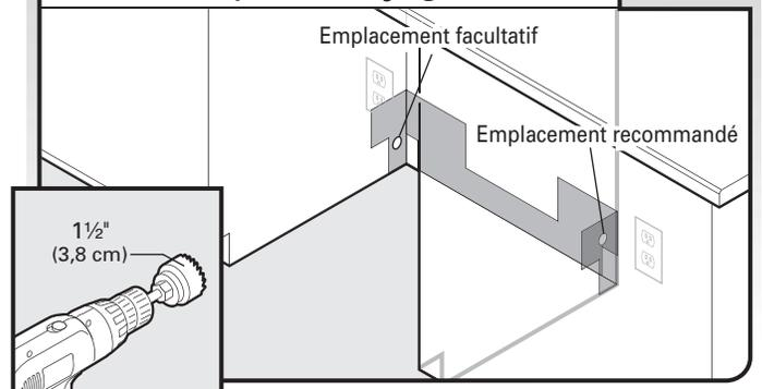
Perçer un trou de 1 1/2" (3,8 cm) dans la paroi latérale ou arrière du placard. Voir les dimensions du produit et de l'ouverture d'encastrement du placard.
