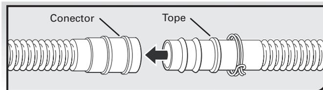
6. Utilice unas pinzas para abrir la abrazadera y deslice la abrazadera en el conector, entre los topes, sobre el conector, como se ilustra.
