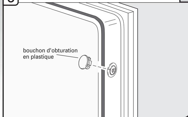
Dans le cas de la fixation sur les placards latéraux, vérifier que les côtés de la porte ne frottent pas contre les têtes de vis. S'il y a frottement, centrer à nouveau le lave-vaisselle. Une fois le lave-vaisselle correctement centré, réinstaller les bouchons d'obturation de plastique.
