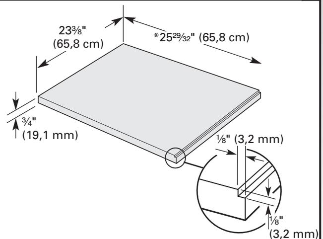
\* Cette dimension est valable pour une bride de calage de 4" (10,2 cm). Si l'installation nécessite une bride de calage plus haute, régler la hauteur du panneau de bois en fonction. Pas recommandé pour les brides de calage supérieures à 6" (15,2 cm).
