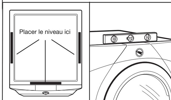
Vérifier l'aplomb de la sécheuse d'un côté à l'autre. Répéter l'opération de l'avant vers l'arrière.
