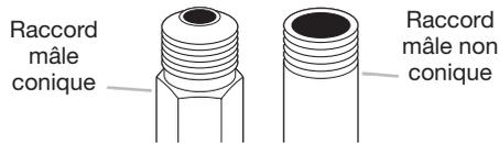
Retirer le capuchon rouge de la canalisation de gaz. À l'aide d'une clé pour serrer, raccorder l'alimentation en gaz à la sècheuse. Utiliser un composé d'étanchéité des tuyauteries sur tous les filetages des raccords mâles non coniques. Si on utilise un conduit métallique souple, veiller à ce qu'il ne soit pas pincé.
