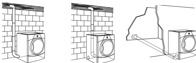
Si vous préférez, cette sècheuse peut être convertie pour évacuer par le côté droit, le côté gauche (tous les modèles, sauf WGD9051Y) ou par le bas. Contactez votre revendeur local pour convertir la sècheuse. Utiliser la trousse d'évacuation à 4 voies pièce n° W10470674.
