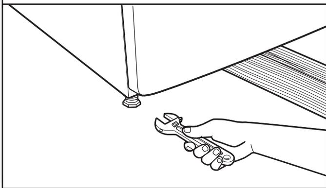
Si la sècheuse n'est pas d'aplomb, la relever à l'aide d'un bloc de bois, utiliser une clé pour ajuster les pieds vers le haut ou vers le bas, et vérifier à nouveau si elle est d'aplomb. Une fois que les pieds sont d'aplomb, s'assurer que les quatre pieds sont solidement appuyés contre le sol avant de les serrer.
