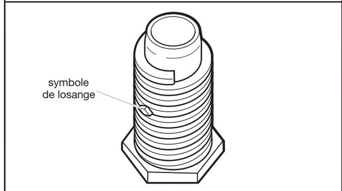
Examiner les pieds de nivellement, trouver le symbole de losange. Introduire manuellement les vis des pieds dans les trous pour pieds, utiliser une clé à molette pour visser les pieds jusqu'à ce que le symbole de losange ne soit plus visible.
