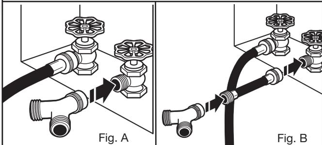
Si l'on a assez d'espace, fixer l'extrémité femelle en laiton du raccord en "Y" au robinet d'eau froide. Voir figure A.
