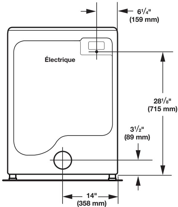
**REMARQUE :** La plupart des installations requièrent un espace minimum de 5" (127 mm) derrière la sècheuse pour le conduit d'évacuation avec coude. Voir "Exigences concernant l'évacuation".
