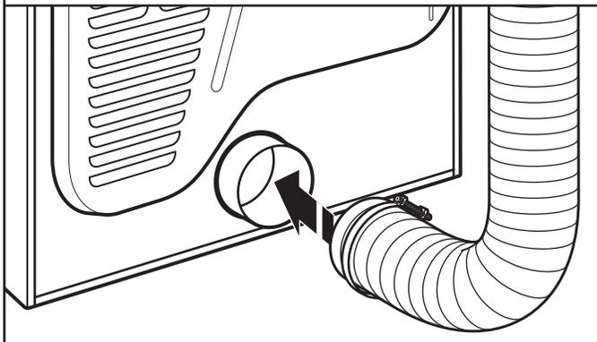
À l'aide d'une bride de serrage de 4" (102 mm), relier le conduit d'évacuation à la bouche d'évacuation de la sécheuse. Si on utilise le conduit d'évacuation existant, s'assurer qu'il est propre. Le conduit d'évacuation de la sécheuse doit être fixé par-dessus la bouche d'évacuation de la sécheuse, et à l'intérieur du clapet d'évacuation. Vérifier que le conduit d'évacuation est fixé au clapet d'évacuation à l'aide d'une bride de serrage de 4" (102 mm).
