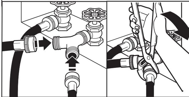
L'une des extrémités du tuyau long comporte un treillis métallique à l'intérieur du raccord. Fixer cette extrémité au connecteur en "Y". Fixer le tuyau d'alimentation en eau froide de la laveuse à l'autre extrémité du raccord en "Y". Visser le raccord à la main pour qu'il repose sur le connecteur. Terminer le serrage des raccords de deux tiers de tour supplémentaire avec une pince.
