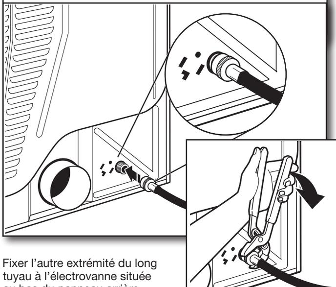
Fixer l'autre extrémité du long tuyau à l'électrovanne située au bas du panneau arrière de la sécheuse. Visser le raccord à la main jusqu'à ce qu'il repose sur le connecteur de l'électrovanne. Terminer le serrage des raccords de deux tiers de tour supplémentaire avec une pince.
