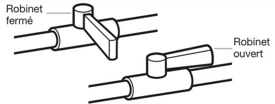
Ouvrir le robinet d'arrêt de la canalisation d'alimentation; le robinet est ouvert lorsque la manette est parallèle à la canalisation de gaz. Vérifier ensuite tous les raccords en les badigeonnant d'une solution de détection des fuites non corrosive approuvée. L'apparition de bulles indique la présence d'une fuite. Réparer toute fuite éventuelle.
