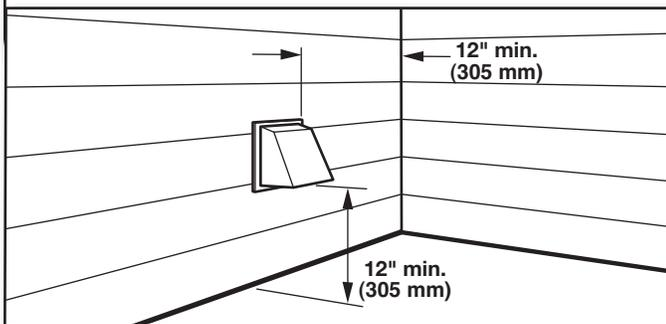
Installer un clapet d'évacuation et calfeutrer l'ouverture murale à l'extérieur autour du clapet d'évacuation.
