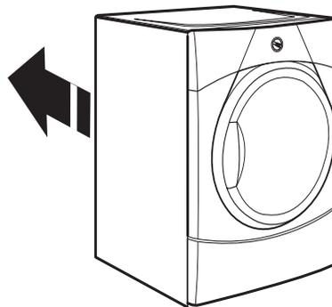
Placer la sécheuse à son emplacement final. Éviter d'écraser ou de déformer le conduit d'évacuation. Une fois que la sécheuse est à son emplacement définitif, ôter le carton du dessous de la sécheuse.
