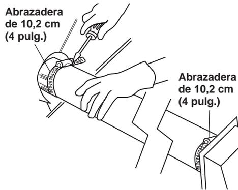
Utilizando una abrazadera de 10,2 cm (4 pulg.), conecte el conducto de salida de aire en el orificio de salida de aire de la secadora. Si está haciendo la conexión en un conducto de salida de aire existente, asegúrese de que el conducto esté limpio.
