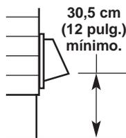
**La campana exterior de salida de aire** debe estar al menos a 30,5 cm (12 pulg.) del suelo o cualquier objeto que pueda interponerse en la vía de salida de aire (como flores, rocas o arbustos, etc.).
