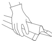
Tome dos ángulos de cartón de la caja de la secadora y colóquelos en el piso detrás de la secadora. Sujete con firmeza la secadora y apoye con cuidado su parte posterior sobre los ángulos de cartón.
