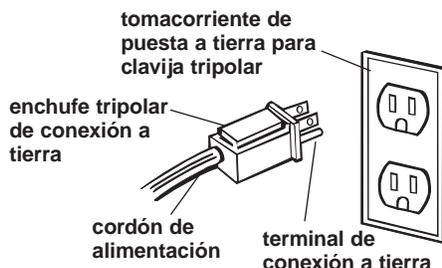
La clavija del cordón de alimentación debe conectarse en un tomacorriente adecuado que haya sido debidamente instalado y puesto a tierra de acuerdo con todos los códigos y reglamentos locales.
