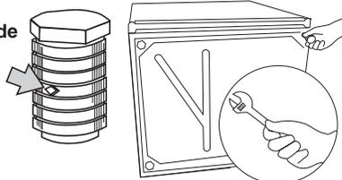
Comience a atornillar las patas en los orificios manualmente. Utilice una llave ajustable o una llave tubular de 2,5 cm (1 pulgada) para terminar de darle vueltas a las patas hasta llegar a la rosca con la marca de rombo.
