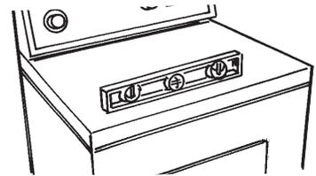
Verifique si la secadora está nivelada, colocando un nivel sobre la secadora, primero de lado a lado, luego de adelante para atrás. Si la secadora no está nivelada, ajuste las patas de la secadora hacia arriba o hacia abajo hasta que esté nivelada.
