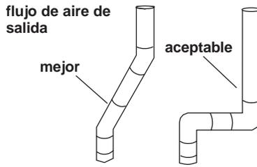
Seleccione la ruta que proporcione la vía más recta y directa hacia el exterior. Planifique la instalación de forma que utilice el menor número de codos y ángulos. Evite hacer ángulos de 90°.
