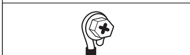
Para conectar los hilos al bloque de terminal, coloque el extremo del hilo en forma de gancho debajo del tornillo del bloque de terminal, mirando hacia la derecha; apriete el extremo en forma de gancho y apriete el tornillo.
