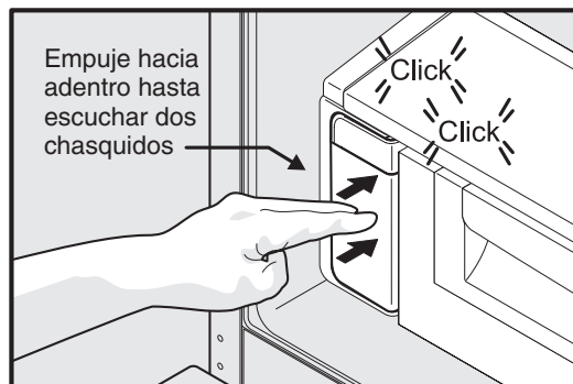
Vuelva a instalar el filtro de agua
