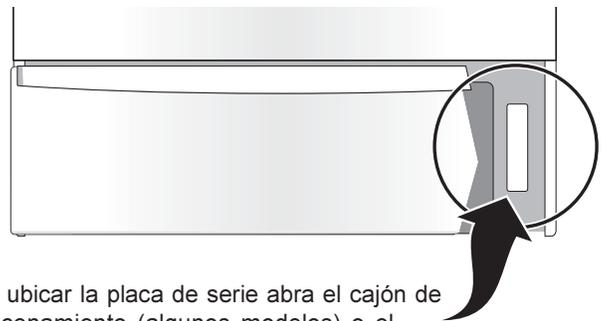
Para ubicar la placa de serie abra el cajón de almacenamiento (algunos modelos) o el cajón calentador (algunos modelos). La placa de serie está instalada en el marco inferior derecho del marco del horno.
