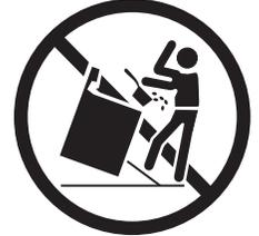
En el caso de los modelos equipados con un cajón calentador o con un horno inferior, sostenga el borde superior trasero de la estufa e intente con cuidado inclinarla hacia adelante. Consulte las instrucciones de instalación para montar correctamente el soporte antivuelco.
