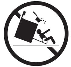
Para reducir el riesgo de vuelco, la estufa debe fijarse con los soportes antivuelco debidamente instalados que se proporcionan con la estufa. Para comprobar que el soporte esté instalado correctamente, verifique visualmente (retire el panel delantero inferior o el cajón de almacenamiento de la estufa) que el tornillo nivelador trasero esté en su lugar y que esté debidamente fijado en posición mediante el soporte antivuelco.
