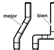
5. Utilice abrazaderas para sellar todas las juntas. No use cinta adhesiva para conductos, tornillos ni otros dispositivos de fijación que se extiendan dentro del conducto de salida de aire, para fijar el conducto.
