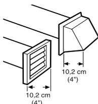
3. El ducto de escape puede ser dirigido hacia arriba, hacia abajo, a la izquierda, derecha y directamente hacia atrás por la parte posterior de la secadora. Los requerimientos de espacio están listados en sus Instrucciones de Instalación.
