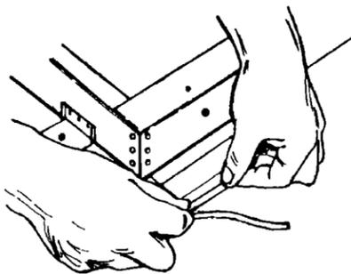
**3.** Ôter l'endos en papier sur une petite section du ruban d'étanchéité en mousse. Placer le ruban à 3,3 mm (1/8 po) du bord de la table de cuisson sur la face inférieure du verre. Poursuivre jusqu'à ce que le ruban en mousse délimite complètement le bord de la table de cuisson. Ne pas utiliser d'autres produits d'étanchéité autour du bord de la table de cuisson.
