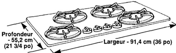
Un placard inférieur de 91,4 cm (36 po) min. est nécessaire. Si le placard comporte un tiroir, un espace de 8,9 cm (3 1/2 po) entre le plan de travail et le haut du tiroir (ou toute autre obstruction) est nécessaire dans le placard inférieur.
