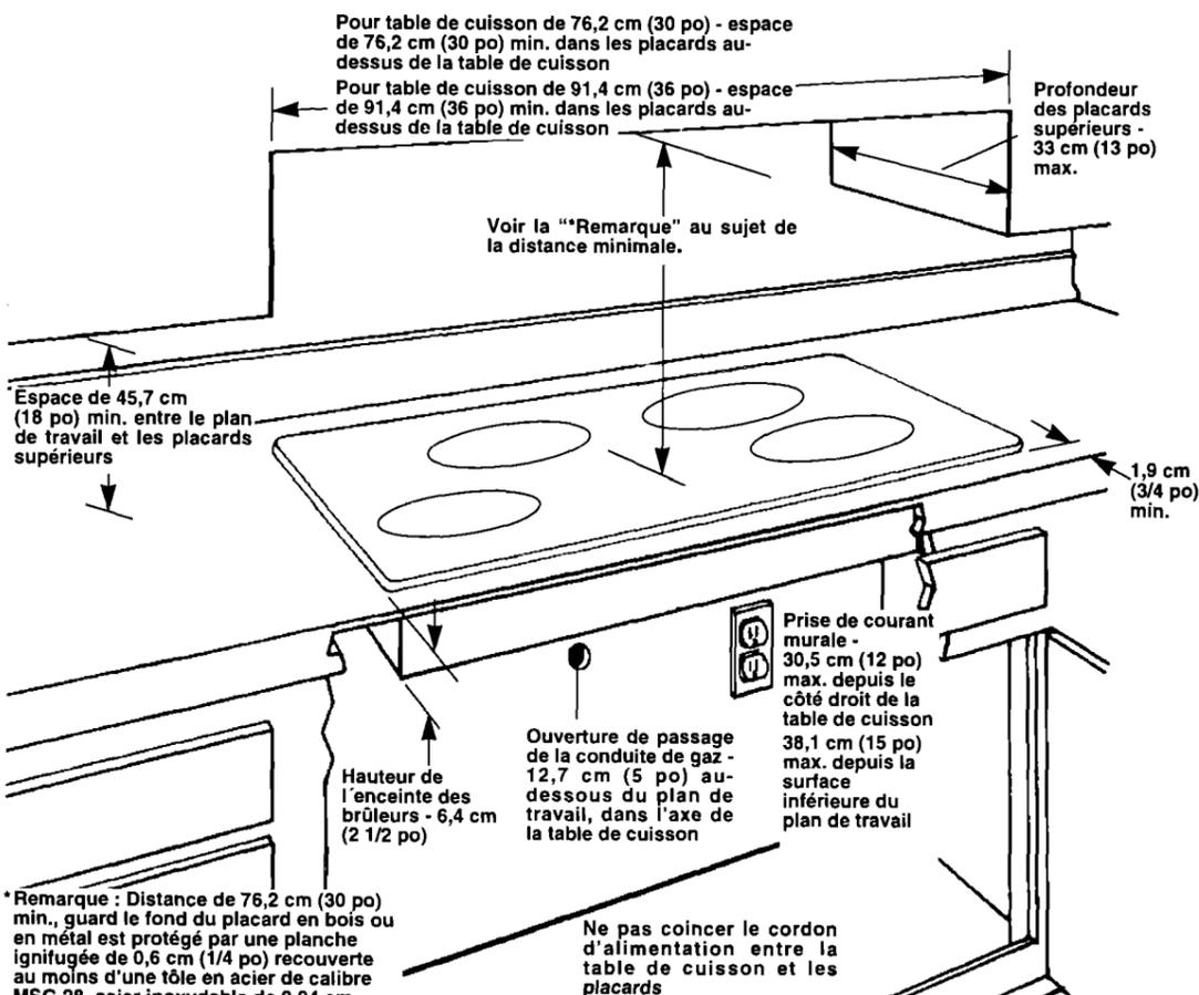
\*Remarque : Distance de 76,2 cm (30 po) min., garde le fond du placard en bois ou en métal est protégé par une planche ignifugée de 0,6 cm (1/4 po) recouverte au moins d'une tôle en acier de calibre MSG 28, acier inoxydable de 0,04 cm (0,015 po), aluminium de 0,06 cm (0,024 po), ou cuivre de 0,05 cm (0,020 po).
