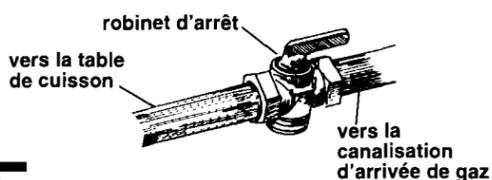
**F.** La canalisation d'arrivée de gaz devra être dotée d'un robinet d'arrêt homologué. Ce robinet d'arrêt devrait être situé dans la même pièce que la table de cuisson, à un emplacement permettant un accès aisé pour les manœuvres d'ouverture et de fermeture. Ne pas entraver l'accès au robinet d'arrêt; celui-ci est utilisé pour l'établissement et l'interruption de l'alimentation en gaz de l'appareil.
