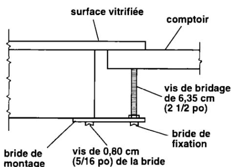
**7.** Orienter les brides de montage du côté opposé à la caisse des brûleurs. Serrer les brides de montage sur la caisse des brûleurs. Insérer les vis de bridage de 6,4 cm (2 1/2 po) dans les brides de montage. Utiliser un tournevis pour serrer la vis contre la face inférieure du comptoir.
