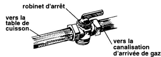
**11.** Ouvrir le robinet d'arrêt de la canalisation de gaz. Attendre pendant quelques minutes que le gaz remplisse la canalisation.
