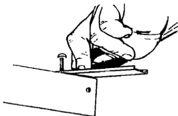
**5.** Fixer les brides de montage de chaque côté de la caisse des brûleurs avec les vis de 0,80 cm (5/16 po). Ne pas encore serrer les vis. Orienter les brides de montage de manière que chaque bride soit sous la caisse des brûleurs.
