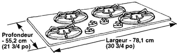
Un placard inférieur de 76,2 cm (30 po) min. est nécessaire. Si le placard comporte un tiroir, un espace de 8,9 cm (3 1/2 po) entre le plan de travail et le haut du tiroir (ou toute autre obstruction) est nécessaire dans le placard inférieur.
