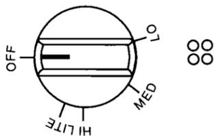
**15.** Contrôler le fonctionnement des brûleurs de la table de cuisson. Appuyer successivement sur le bouton de commande de chaque brûleur et faire tourner le bouton jusqu'à la position "LITE". Le brûleur devrait s'allumer en moins de 4 secondes. **Nes pas laisser le bouton à la position "LITE" une fois le brûleur allumé.**
