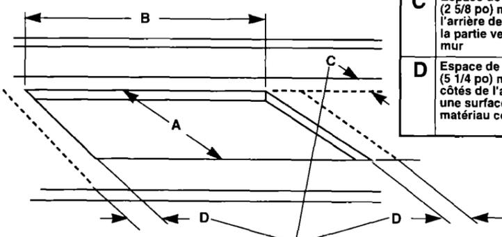
Distance de séparation minimale par rapport à une surface de matériau combustible au-dessus du plan de travail, sur les côtés et à l'arrière.
