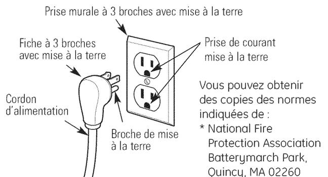
Pour réduire au minimum les risques de chocs électriques, la fiche doit être branchée dans une prise de courant murale à trois alvéoles mise à la terre en conformité avec la version la plus récente de la norme ANSI/NFPA 70 du National Electrical Code et avec tous les codes et ordonnances locaux en vigueur.
