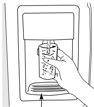
Bac de trop-plein
