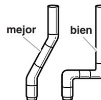
4. Utilice abrazaderas para sellar todas las uniones. No use cinta adhesiva para conductos, tornillos ni otros dispositivos de fijación que se extiendan dentro del ducto de escape, para fijar el ducto.
