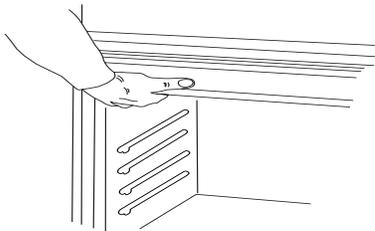
2. Pousser contre la zone du joint du châssis avant pour introduire le four dans le placard.
