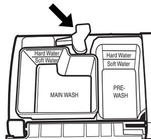
2. Verser la quantité adaptée de détergent dans la section de lavage principal du distributeur en vous référant au tableau ci-dessous. En cas d'utilisation de détergent en pastilles, celles-ci doivent être placées dans la section de lavage principal. (Voir "Quantité de détergent à utiliser".)
