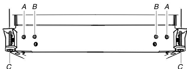
A. Vis de réglage avant B. Vis de réglage arrière C. Pied de stabilisation
